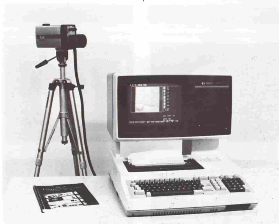
Fig. 4(a) - Sistema termografico AGA THERMOVISION completo di sistema digitale per la presentazione delle immagini termiche a colori ed a frequenze TV. (b) - Sistema termografico AGA THERMOVISION completo di personal computer per l'elaborazione dei termogrammi.
