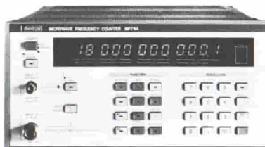
Frequenzimetro operante nella banda da 10 Hz fino a 18 GHz.
