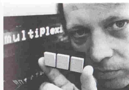
Nuovi display a matrice, completi di logica di comando, quindi sufficientemente "intelligenti" per generare 96 numeri e caratteri partendo da un semplice codice ASCII.
