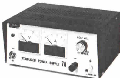
Alimentatore stabilizzato "G.B.C." Con strumenti di misura e protezione elettronica contro il cortocircuito Tensione d'ingresso: 220 V - 50 Hz Tensione d'uscita regolabile: 6 ÷ 14 Vc.c. Corrente max d'uscita: 8 A Dimensioni: 200 x 190 x 100 NT/0528-00
