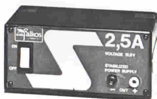
Alimentatore stabilizzato "FALKOS" Con protezione elettronica. Tensione di ingresso: 220 V - 50 Hz Tensione d'uscita: 12,6 Vc.c. Corrente d'uscita: 2,5 A Dimensioni: 160 x 75 x 115 NT/0050-00
