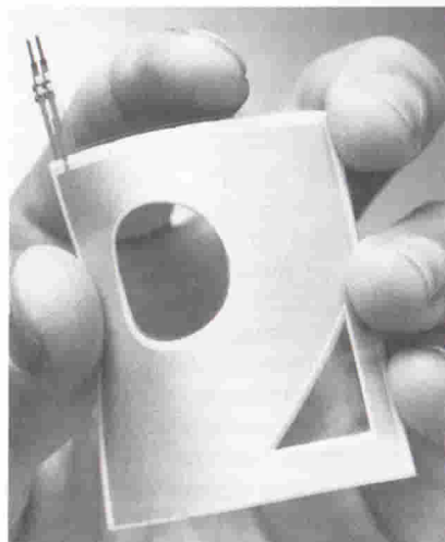
Lampade elettroluminescenti adatte per l'impiego in display a cristalli liquidi, strumentazione da veicolo, apparecchi telefonici; tra l'altro sono molto resistenti agli urti e alle vibrazioni e possono essere impiegate in ambienti severi.
