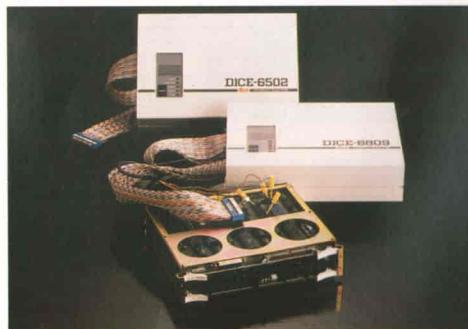
Fig. 1 - La famiglia di emulatori DICE della Unidux possiede caratteristiche interessanti, come il trigger sequenziale ed il doppio bus interno.
