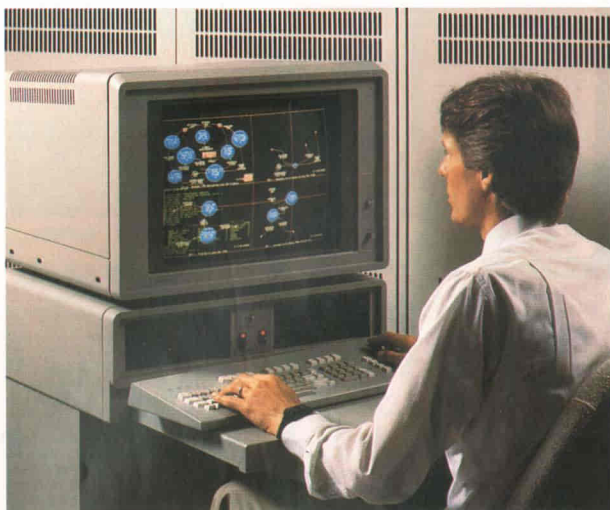
Fig. 7 - Tramite i pacchetti per la analisi strutturata, si possono generare schemi a blocchi del sistema finale, per poi analizzarli automaticamente e scoprire errori ed incompatibilità. (Foto TEKTRONIX)
