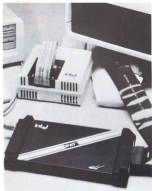
Fig. 4 - Il modulo IPAT (Intel Performance Analysis Tool), collegabile all'ICE, permette di misurare ed ottimizzare le prestazioni del programma sotto test.
