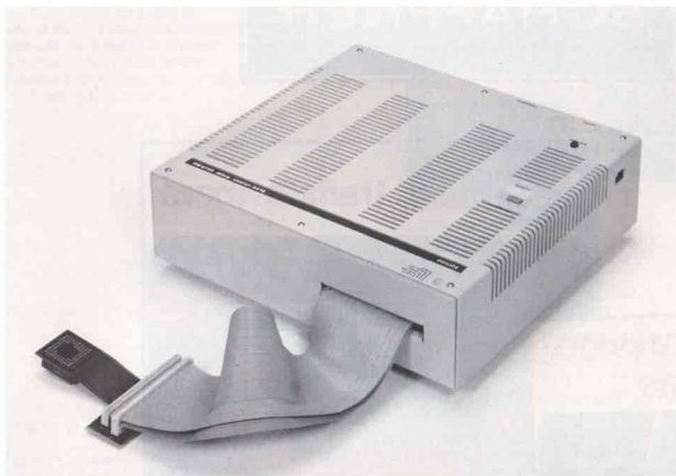
Fig. 6 - Gli SDS sono emulatori da collegare ad un Personal Computer o ad un grosso calcolatore tramite una linea seriale.
