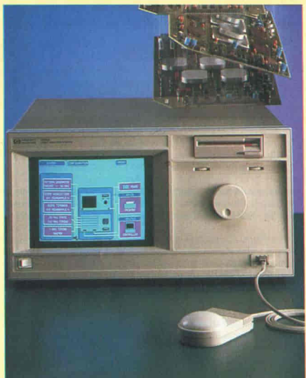
Il sistema logic analyzer HP 16500, realizzato secondo la tecnologia dello "strumento su un chip".
