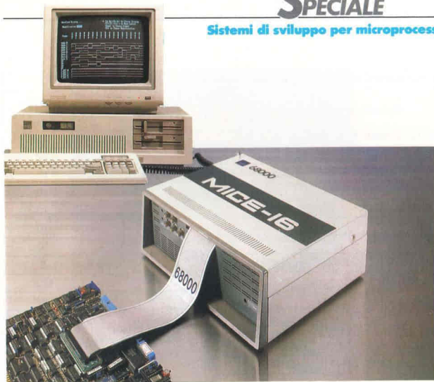
Fig. 7 - Gli emulatori della serie MICE-16 sono dedicati ai microprocessori a 16 bit sia della Motorola che della Intel.
