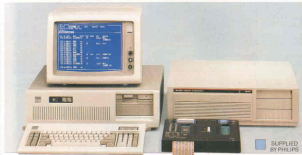
Fig. 2 - Con il PMDS III è possibile aprire fino a 3 finestre sul video, ognuna delle quali contiene dati diversi; tutte le finestre vengono aggiornate contemporaneamente.
