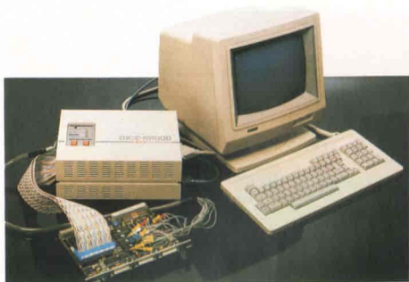
Fig. 7 - Un sistema di sviluppo composto da un emulatore ed un personal computer sfrutta la potenza del calcolatore per sviluppare il software e l'emulazione stand-alone per la sua messa a punto.
