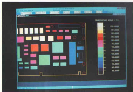
Con il software AutoTherm si possono ottenere automaticamente mappe delle temperature di giunzione di un circuito.
