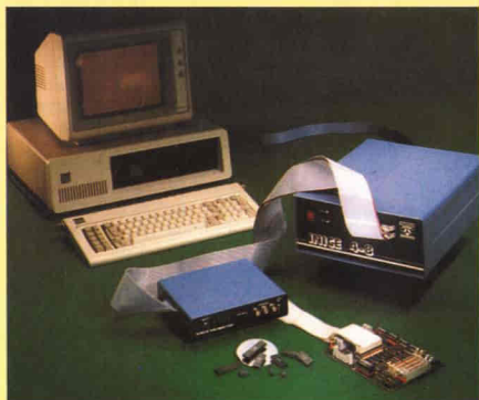
Figura A - L'emulazione INICE 4-8 può supportare tutti i microprocessori prodotti dalla Thomson ed è basato su di un Personal Computer.
