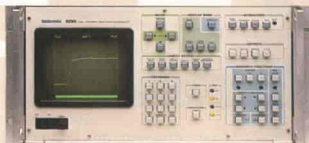
Tek 7250 Transient digitizer oscilloscope - Banda passante 6 GHz - Tempo di salita 50 psec
