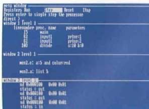
Fig. 2 - Con il PMDS III è possibile aprire fino a 3 finestre sul video, ognuna delle quali contiene dati diversi; tutte le finestre vengono aggiornate contemporaneamente.
