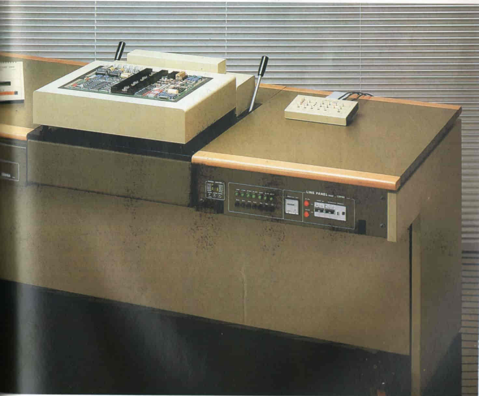
Fig. 5 - Le macchine di test della serie AFL (Automatic Fault Locator) hanno alcune caratteristiche interessanti, nonostante il costo ridotto.
