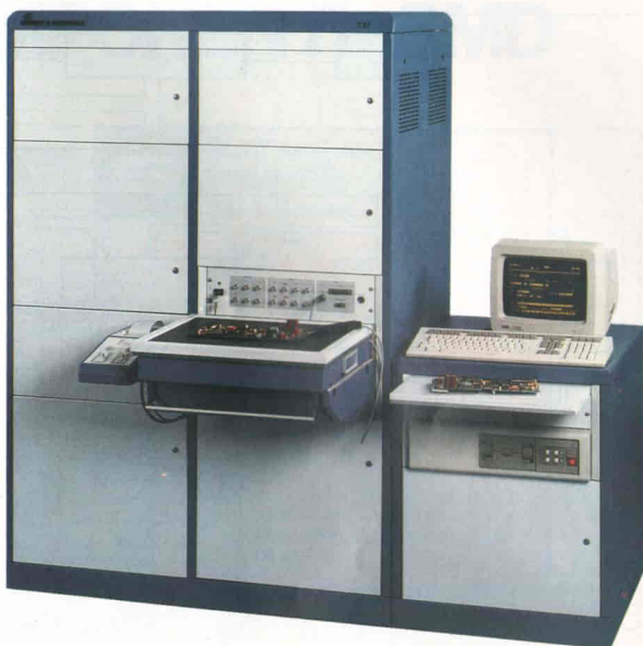
Fig. 1 - Il sistema di test TSI effettua il test di tipo in-circuit di schede contenenti sia circuiti integrati digitali che circuiti analogici.
