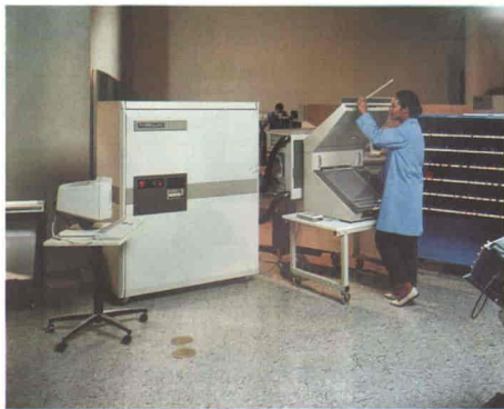
Fig. 4 - Il nuovo sistema GR125 per il collaudo dei componenti VLSI introduce architetture ed elevate prestazioni tipiche fino ad oggi di sistemi più costosi e sofisticati.
