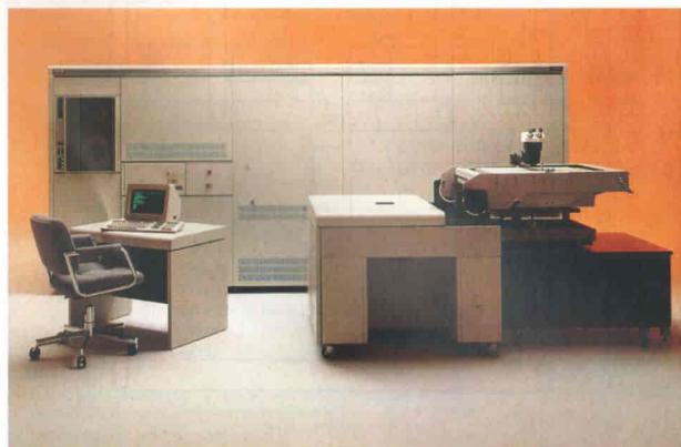
Fig. 5 - La macchina di test S 50 è in grado di gestire fino a 512 pins alla frequenza di 50 MHz.
