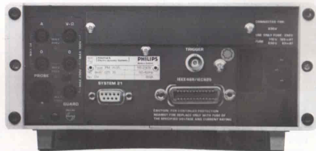
Fig. 2 - Vista posteriore del PM2535; vicino al connettore IEEE 488, si nota quello a 9 contatti con cui il multimetro si collega alle unità scanner del System 21.
