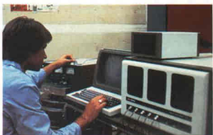
Fig. 7 - In primo piano, sistema GenRad 2511/14 per il controllo delle vibrazioni in circuito chiuso. È utilizzato sia per qualificare i prototipi che per il controllo della produzione di apparati.
