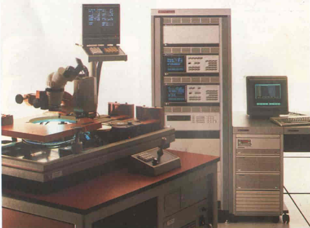
Fig. 5 - Il sistema di test HP 81810S è in grado di collaudare circuiti integrati digitali alla frequenza di 50 MHz.
