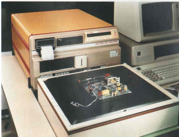
Fig. 1 - La ETI 120 è una compatta e flessibile macchina per il test di schede. Nella foto si vede una applicazione nel campo della telefonia.
