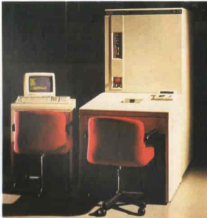
Fig. 7 - La macchina di test S 15 è in grado di gestire fino a 256 pins alla frequenza di 20 MHz.
