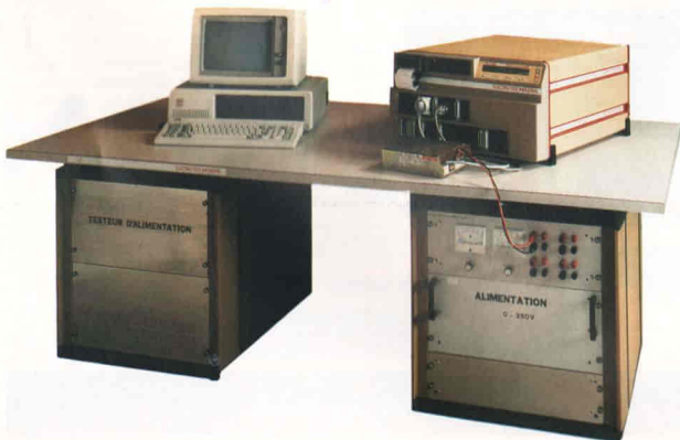
Fig. 4 - La ETI 121 è stata studiata appositamente per il test degli alimentatori.
