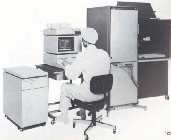
Fig. 2 - Il sistema HP 4063A esegue il collaudo parametrico dei semiconduttori per la messa a punto dei materiali e dei processi produttivi.
