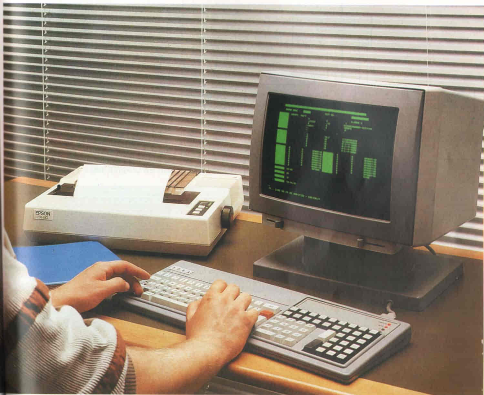
Fig. 2 - Le macchine della serie Digitest sono in grado di eseguire test, sia di tipo in-circuit che funzionale, su schede digitali, contenenti anche circuiti integrati LSI e VLSI.
