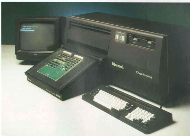
Fig. 1 - Il checkmate è un sistema automatico di test di tipo economico che, per la sua flessibilità, è adatto a diverse situazioni.
