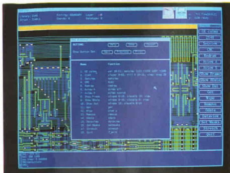
Fig. 3 - Con i menù programmabili è possibile per l'utente definire pagine di comandi per specifiche applicazioni, come ad esempio la costruzione di transistor CMOS, di contatti e così via.
