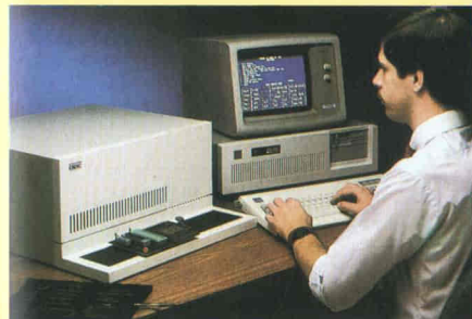
Fig. 1 - La Cadic STM 5100 permette di verificare i prototipi dei circuiti integrati VLSI, senza la necessità di collegamenti esterni sfruttando la architettura delle macchine usate in produzione.
