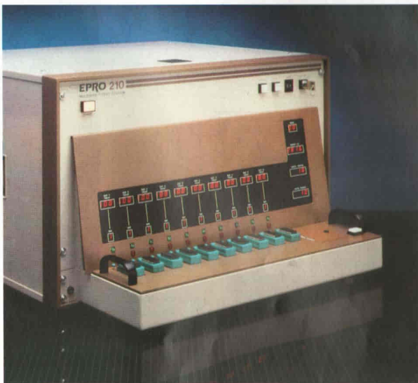
Fig. 1 - La Epro 210 Multisite™ è in grado di testare contemporaneamente fino a 10 memorie EPROM, EEPROM o NOVRAM.
