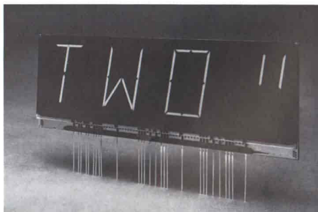
Display a scarica nel gas a 4 caratteri su matrice di 16 segmenti prodotto dalla BABCOCK.
