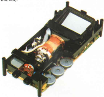
Fig. E - Modulo con display CRT piatto della Sony, versione FDM-21 con diagonale di 2 pollici dello schermo. Lo spessore è di 35 mm. Il peso è 220 g.
