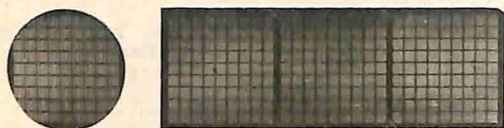
Fig. 2 - La tavoletta da 50 x 150 mm di destra consente una maggiore economia di materiale, in confronto con il disco riprodotto a sinistra.
