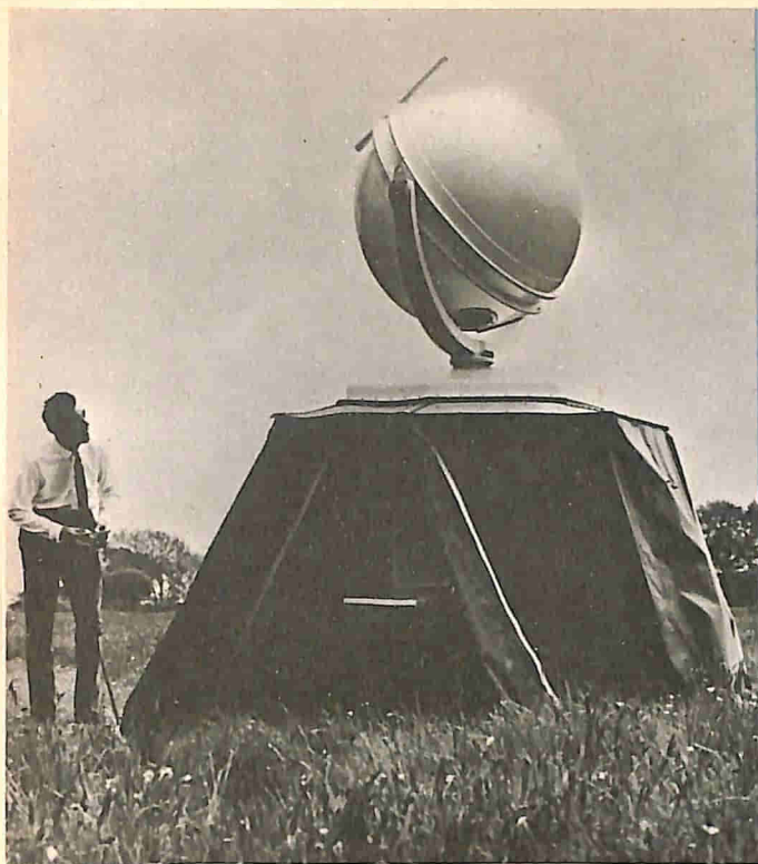
Fig. 1 - Il radar WF.3 per la ricerca dei venti viene puntato su un bersaglio da un operatore, il quale impiega l'unità di controllo a distanza.
