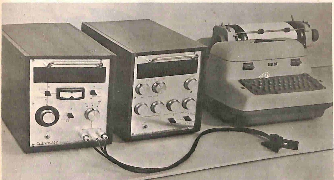
Fig. 2 - Complesso comprendente un ponte automatico Cultron ed una stampatrice.
