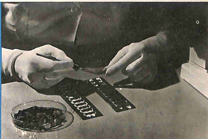
Fig. 3 - Una fase di lavorazione dei microcircuiti S.G.S., che saranno racchiusi in contenitore DIP.
