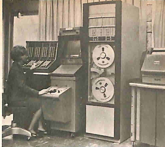
In questo sistema fax, documenti presi da un archivio di microfilm vengono esplorati e registrati ad alta velocità per la trasmissione successiva a bassa velocità sulle linee telefoniche.
