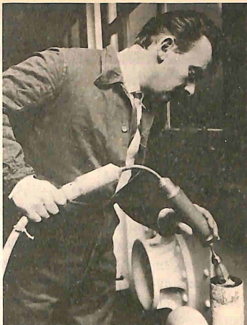
Questa telecamera articolata, realizzata ancora dai Pye Laboratory Ltd., che qui vediamo mentre viene fatta scendere nel tubo di ventilazione di un serbatoio a doppio fondo di un transatlantico, è la più piccola del genere finora esistente.
