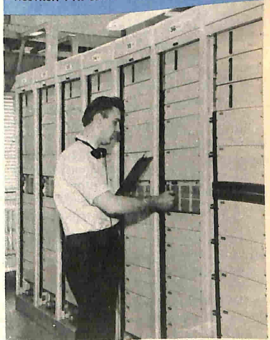
Fig. 1 - In questa fotografia sono visibili alcuni ricevitori PVR 800 a bande laterali indipendenti.
