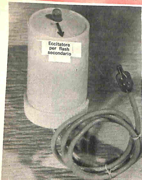
Fig. 3 - L'estremità sensibile della fotoresistenza deve sporgere da un'estremità della scatola, come si vede in questa illustrazione.
