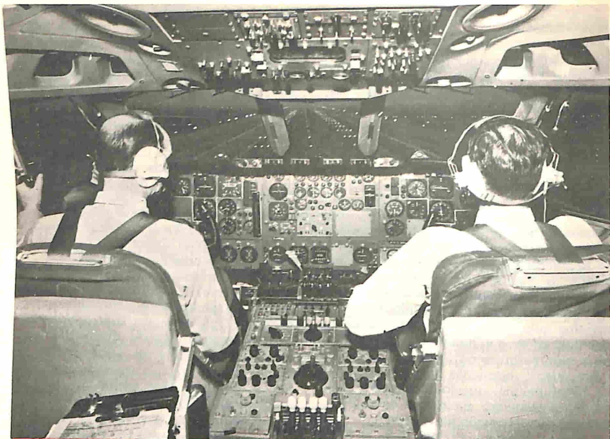
Interno del posto di pilotaggio di un velivolo di linea Super VC. 10, durante una manovra di atterraggio automatico compiuto per mezzo dei nuovi dispositivi installati a bordo.
