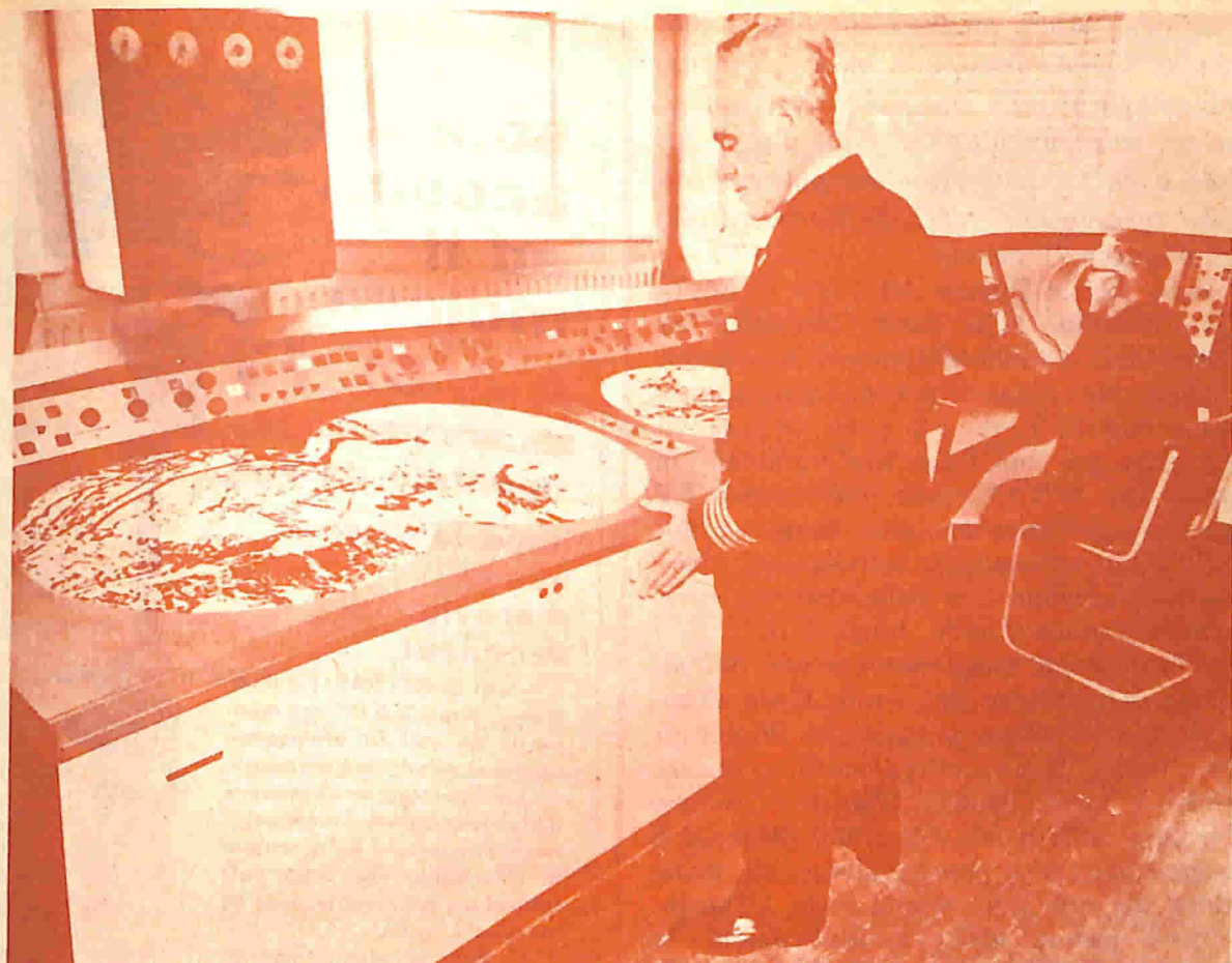
Sala di controllo del sistema radar portuale del Tee. I due schermi Photoplot visibili in primo piano presentano l'immagine completa dell'estuario del fiume, nonché dei suoi accessi.
