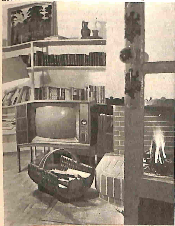
Esemplare di apparecchio TV Bildmeister FF 90 Electronic a colori, prodotto dalla Siemens, dotato di cromoscopia da 63 cm di larghezza e di sette tasti per la scelta del programma.
