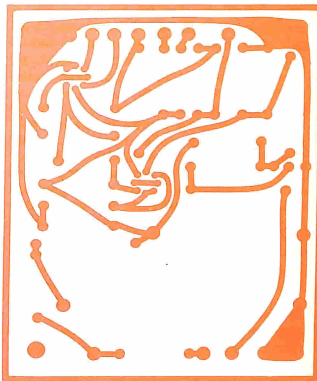
Fig. 5 - Circuito stampato in grandezza naturale; su esso si devono praticare i fori indicati nella fig. 2 e montare le parti illustrate nella fig. 3.
