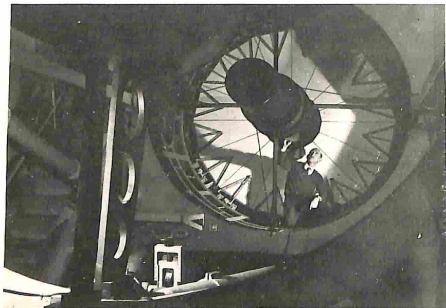
Fig. 2 - Un collaudatore esamina l'involucro a petali del telescopio britannico Isaac Newton da 250 cm di diametro.
