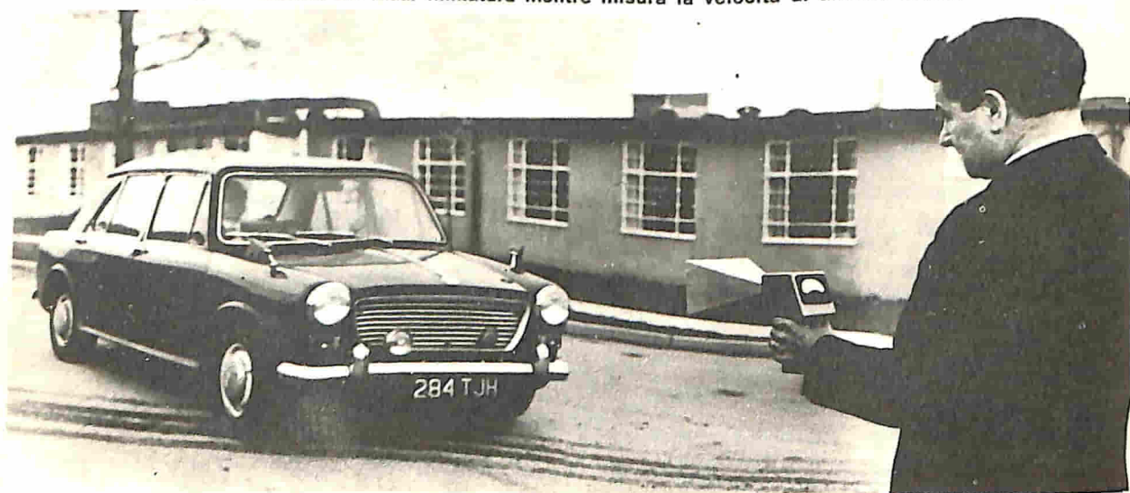
Fig. 4 - Tachimetro radar miniatura mentre misura la velocità di un'autovettura.
