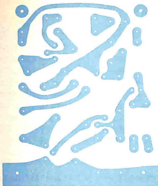
Fig. 2 - Circuito stampato in grandezza naturale per l'amplificatore. I due transistori di potenza ed i componenti ad essi relativi, a causa del calore dissipato, sono montati esternamente.
