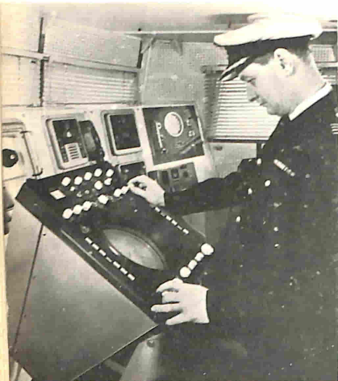
Unità di presentazione del radar a transistori Raymarc 12, installato nel salone di dimostrazione del battello di ricerca Elettra III della Marconi.
