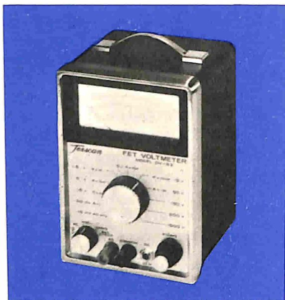
Fig. 6 - Voltmetro a transistori con effetto di campo, « Mod. DV-93 », realizzato dalla Texas Corporation, alimentabile a rete oa a batteria.
