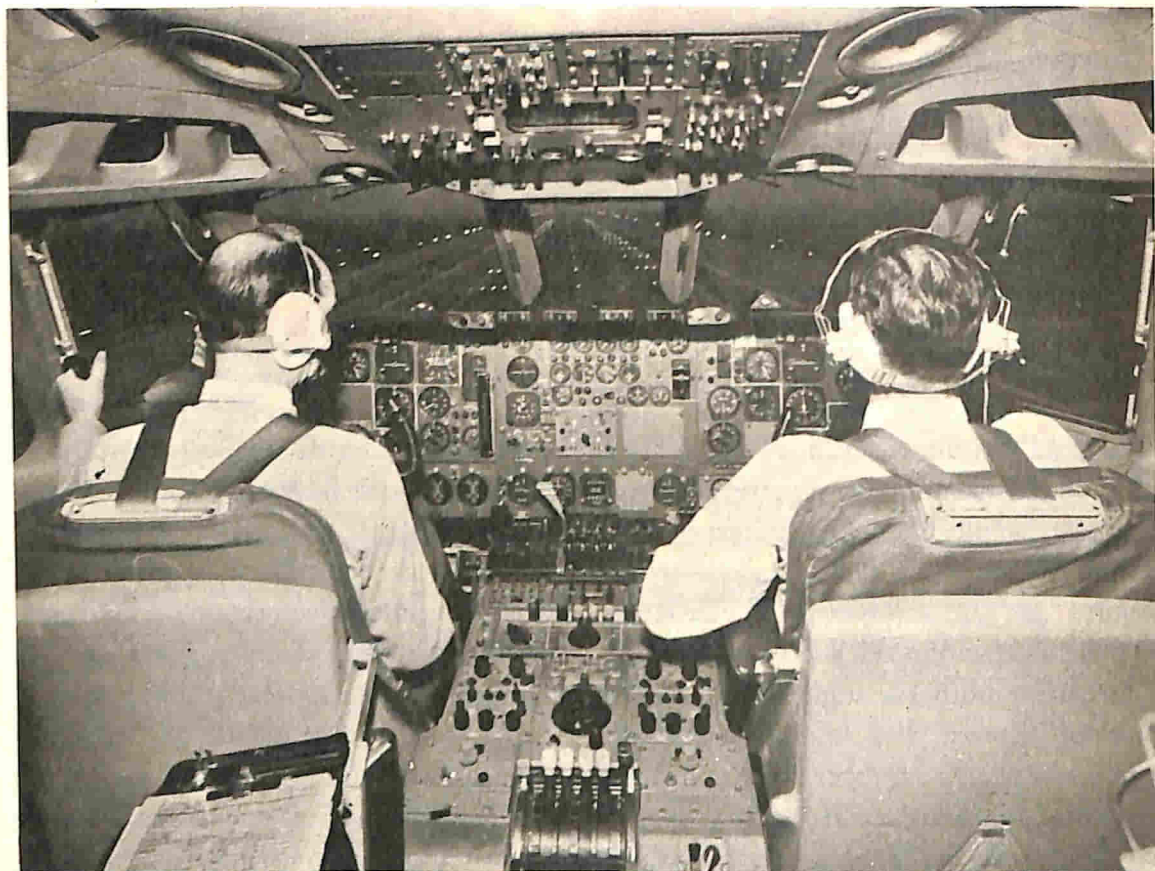
Fig. 2 - Ecco come appare il posto di comando del reattore di linea Super VC10 G-ASGG mentre effettua un atterraggio automatico « senza mani » nell'aeroporto della Royal Aircraft Establishment.
