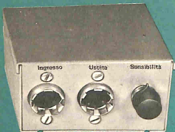
Fig. 7 - Montando l'interruttore sul controllo della sensibilità, si ottiene una semplice unità, facile da azionare, controllata mediante un'unica manopola. I jack d'ingresso e d'uscita possono essere di qualsiasi tipo, purché con 4 piedini.
