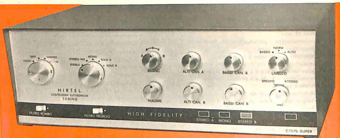
Fig. 8 - Da questa illustrazione, in cui è riportato l'amplificatore a montaggio ultimato, è chiaramente visibile l'ordinata disposizione dei numerosi comandi installati sul pannello frontale del complesso.
