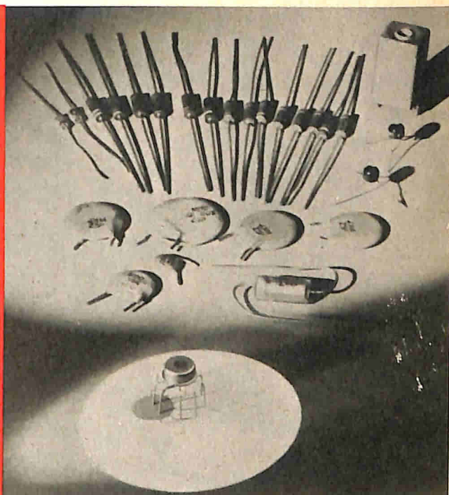
Fig. 4 - Il circuito integrato della RCA, visibile in basso al centro del cerchio di luce, può svolgere le stesse funzioni di tutti i componenti elettronici disposti sullo sfondo.
