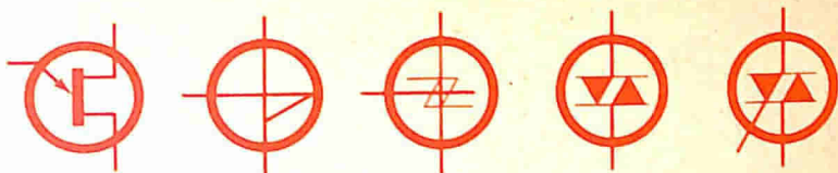
Fig. 3 - Ecco alcuni dei più importanti simboli usati per raffigurare dispositivi di controllo e di commutazione.
