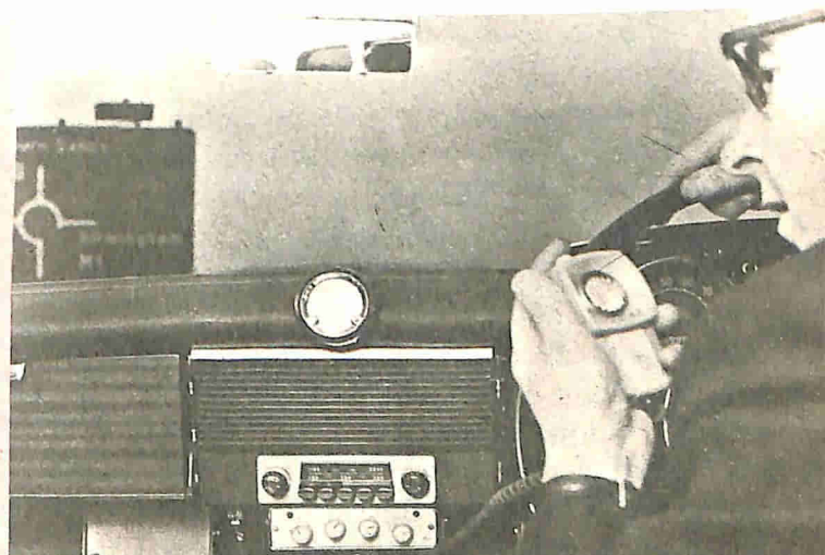
Fig. 2 - Il sistema radio VHF della Pye permette agli uomini d'affari di mantenersi in continuo contatto con il mondo esterno anche quando sono alla guida.
