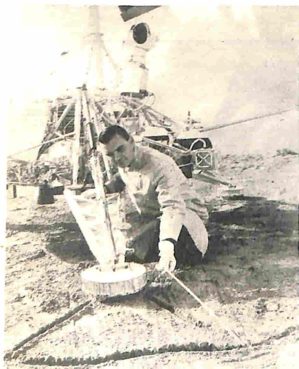
Fig. 4 - I dinamometri elettronici hanno reso possibile il controllo e la trasmissione a terra, via radio, di ogni informazione relativa alla discesa "dolce" sulla Luna del "Surveyor 1".
