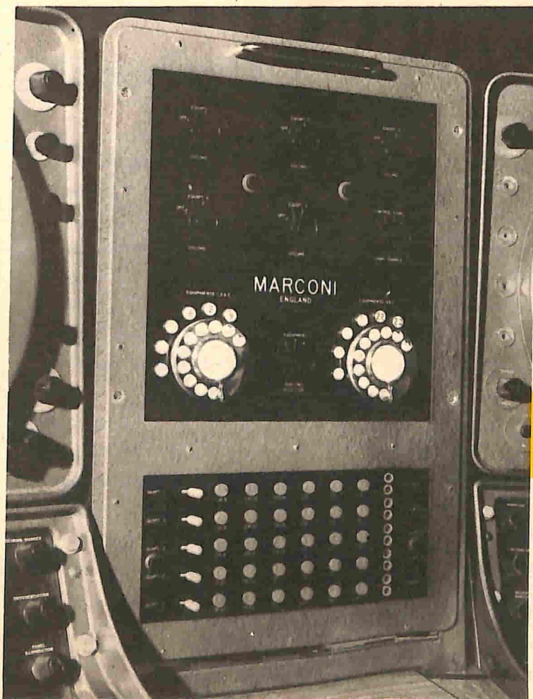
Il pannello di controllo radio VHF comprende i controlli, i servizi di ricerca (in alto) e il selettore di canale RT (in basso).
