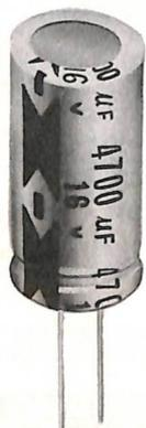
**Figura 6.** Elettrolitici: meglio abbondare sempre nella tensione di lavoro e attenzione a inserirli in circuito con la giusta polarità...
