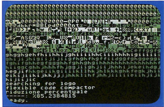
Durante la compattazione la memoria riservata allo schermo è usata come buffer, evitando interferenze fra Gigapack e il programma in memoria.
