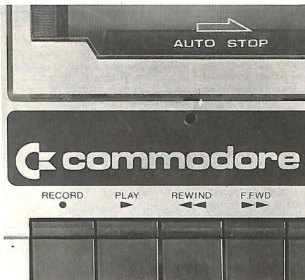
Figura 1. Nella fotografia è evidenziato il foro attraverso il quale è possibile regolare la vite di registrazione della testina.
