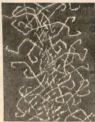
Fig. 2. Fotografia in Camera di Wilson: elettroni strappati all'aria da raggi X per effetto fotoelettrico.
