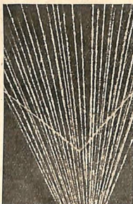
Fig. 3. Fotografia in Camera di Wilson: bombardamento, con raggi «alfa», di gas elio.
