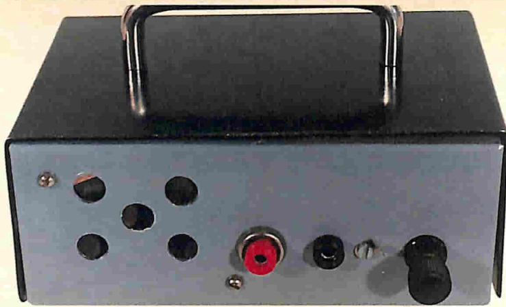
Figura 3. Sul pannello posteriore, i fori per l'altoparlante, le boccole per l'alimentatore, per l'antenna esterna e per la presa di terra.
