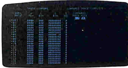
Fig. 12 - Il modo "trace compare" offre un confronto del tipo OR esclusivo tra i dati memorizzati in funzione di quelli attivi.
