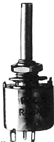
Tipo K MIL RV4 2 Watt a 70°C 500 Volt 50 Ohm ÷ 5 MOhm
