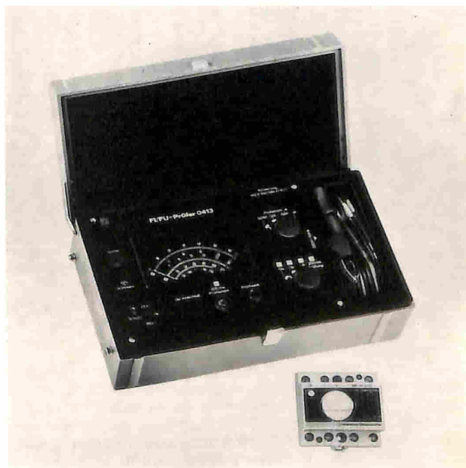
Prova automatica degli interruttori di sicurezza di sovracorrente e di sovratensione secondo la VDE 0100 g con il tester FI/FU 0413.
