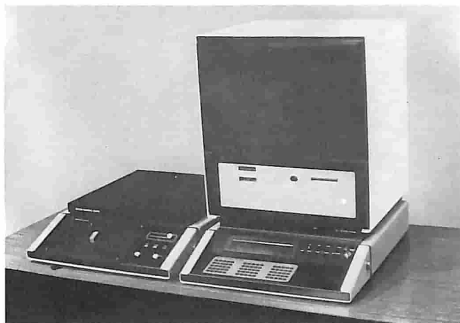
Sistema automatico per la prova rapida di reti e di moduli della GenRad.
