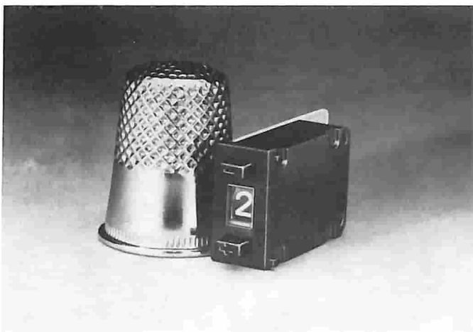
Commutatore di codifica subminiatura della Alcoswitch
