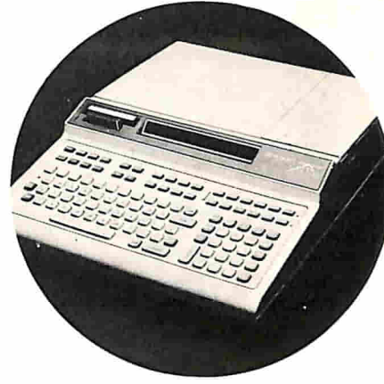
HP-9831. Memoria interna da 8K a 32K byte. Cartuccia dati a ricerca bidirezionale, veloce, con capacità 250K byte. Tasti speciali per accedere fino a 24 programmi preregistrati battendo uno o due tasti. Programmato in BASIC, linguaggio facile e potente.
