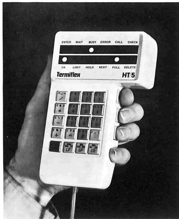
Il primo terminale portatile interattivo alfanumerico dotato di tastiera a 20 tasti e con velocità di trasmissione dati regolabile.
