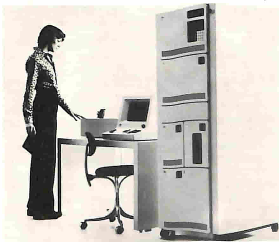
La Serie / 1 IBM. Questo nuovo sistema per l'elaborazione dati è particolarmente compatto; l'unità di elaborazione e gran parte delle unità periferiche hanno larghezza standard di 48 o 24 cm.
