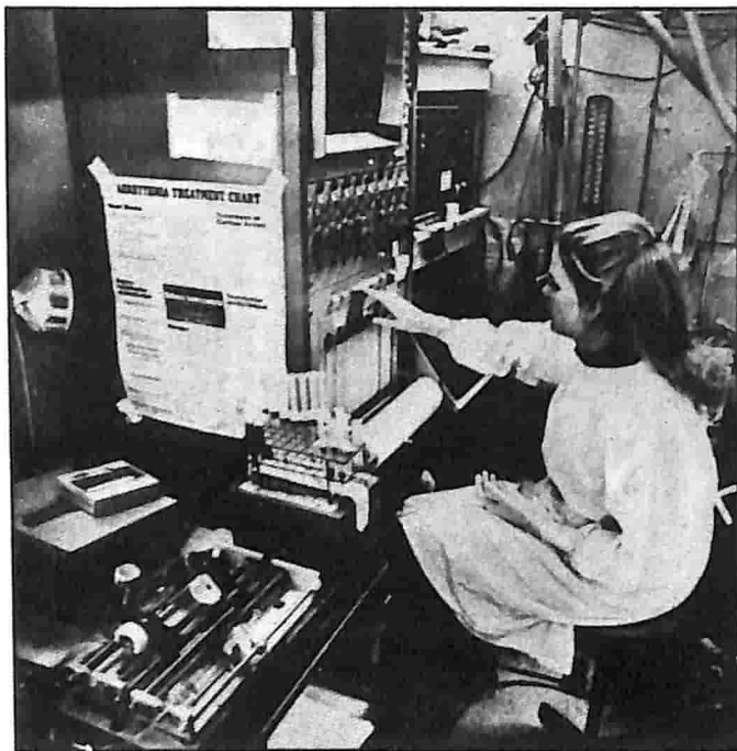
Fig. 7-A- Il registratore visibile in questa foto fornisce grafici permanenti relativi ad otto parametri di un unico paziente, riferiti tutti ad una stessa base dei tempi.
