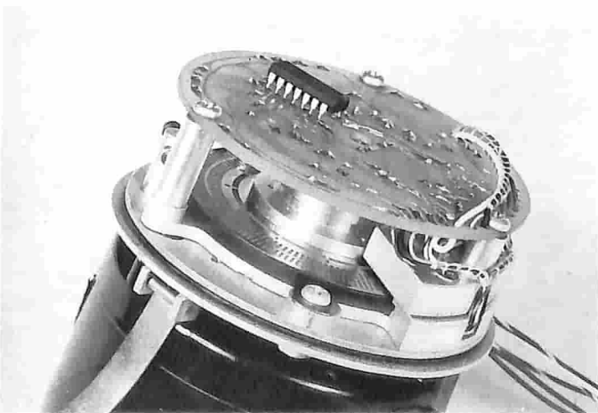
Encoder incrementale ottico per servomotori e motori passo-passo della Moore Reed.
