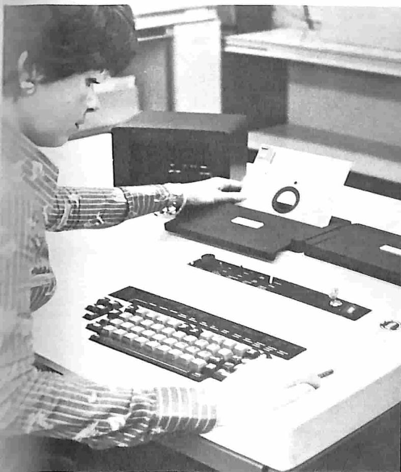
Il nuovo sistema di registrazione dati su floppy-disk Transdata 920. All'unità può essere collegata una stampante a matrice e la trasmissione dei dati può essere effettuata con procedure di programmazione.
