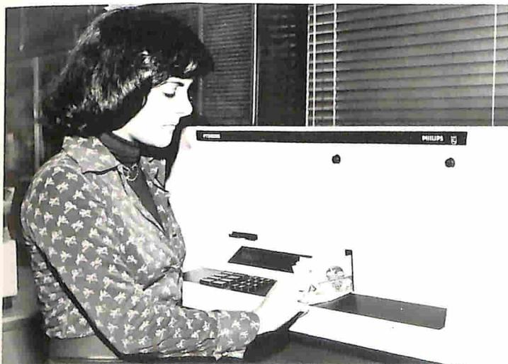
Con il C.O.T. Philips, sono sufficienti tre semplici operazioni (introduzione della scheda, digitazione del proprio codice segreto e dell'importo) per poter prelevare denaro dal proprio conto.
