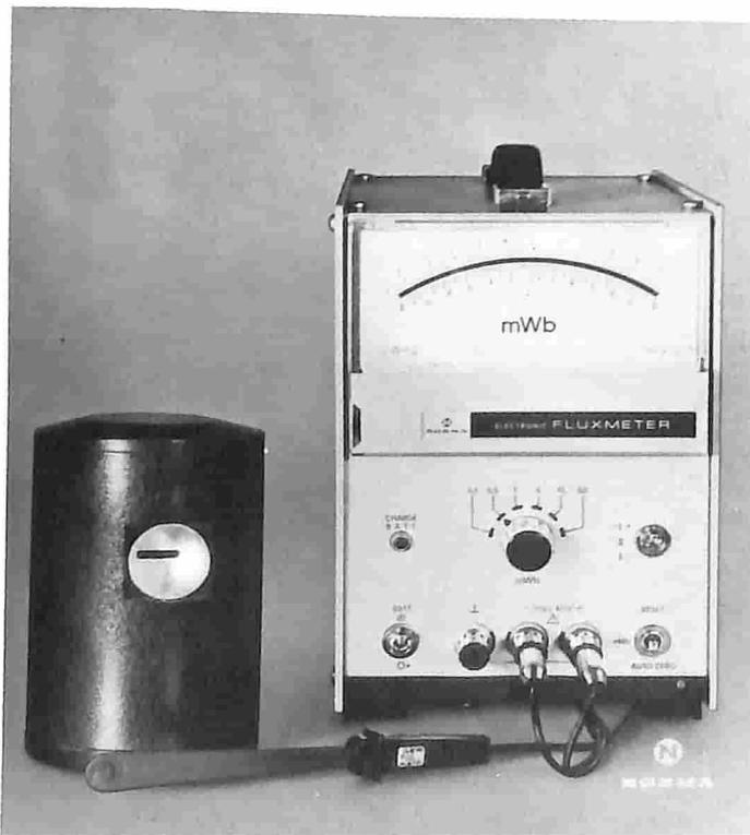
Il nuovo "Electronic Fluxmeter" della Norma adatto a misurare il flusso e l'induzione di magneti permanenti. Lo strumento ha un esteso campo di misura da 0,1 a 50mWb e da 10 a 5000mAs.
