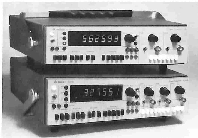
Il TC311 e il TC314 sono due nuovi contatori-misuratori di intervalli di tempo operanti fra 0  $\div$  10MHz e 20Hz  $\div$  50MHz in grado di effettuare svariate misure ad alta risoluzione.
