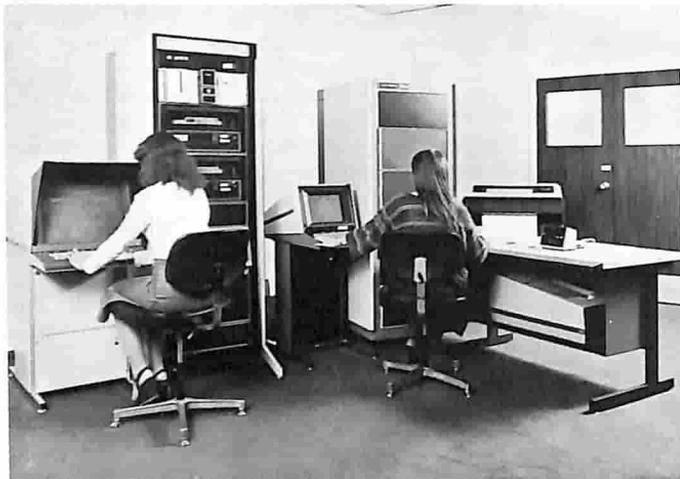
Insieme completo del sistema di prova delle memorie Tektronix S3455; è mostrata la possibilità di un accesso multiplo da parte degli utilizzatori.
