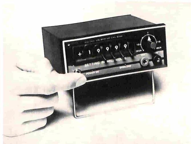
Molto piccolo e compatto, questo nuovo calibratore della Datel genera all'uscita fino a  $\pm 19,999\text{V}$  a  $25\text{mA}$  con una precisione dello  $0,005\%$  sul fondo scala.
