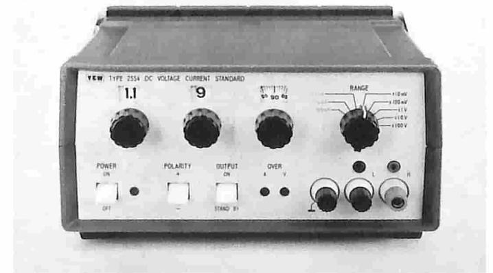
Compattezza e facilità d'uso sono delle caratteristiche interessanti di questo calibratore portatile che ha una precisione del  $\pm 0,05\%$  nella gamma di tensioni 0  $\div$  120V e correnti 0  $\div$  120mA.
