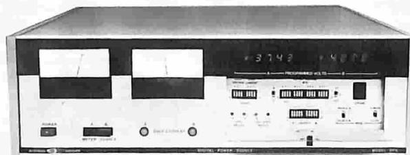
Lo sportello aperto sulla destra del pannello frontale mostra i vari interruttori atti a programmare le due uscite di questo alimentatore stabilizzato. Le tensioni disponibili sono entrambe da 0 a 50V con correnti massime di 1A.
