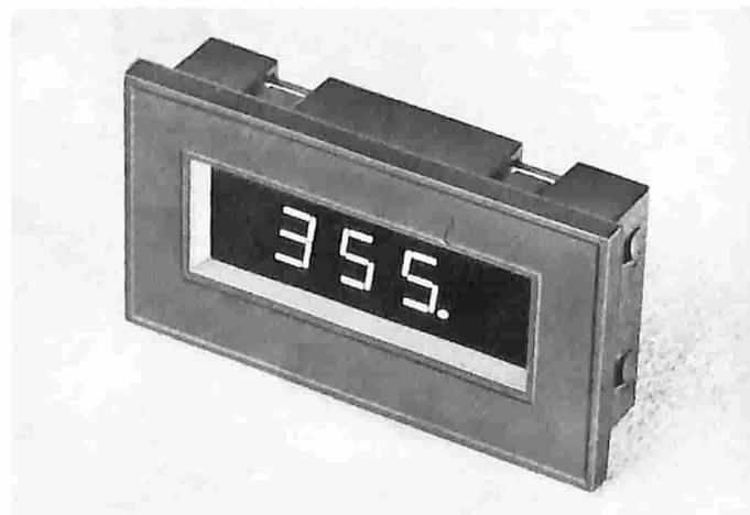
Voltmetro digitale da pannello AD2026 studiato per sostituire gli equivalenti voltmetri analogici. Lo strumento è alimentato a +5Vcc e indica tensioni che vanno da -99mV a +999mV.
