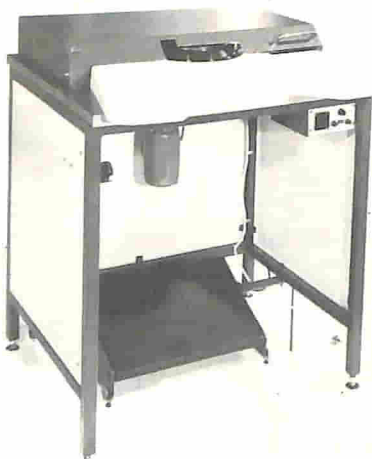
Fig. 17 - Apparecchiatura automatica per il taglio e la piegatura dei terminali di transistori, per lo snellimento dei lavori di montaggio delle basette a circuiti stampati.
