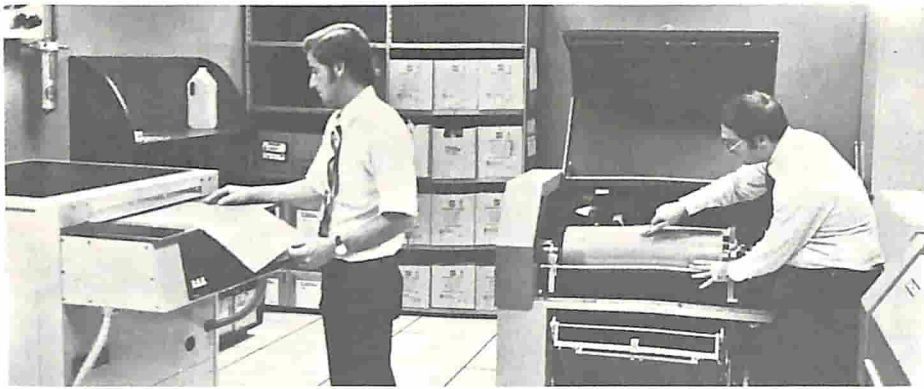
Fig. 9 - Esempio di ufficio nel quale sono presenti simultaneamente un elaboratore dei dati con stampante, ed un'apparecchiatura in "fac-simile", per l'inoltro simultaneo di disegni, fotografie, ecc.
