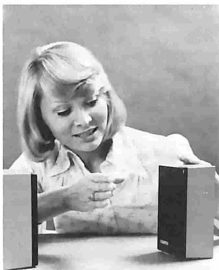
Fig. 1 - Il nuovo sistema di protezione IS 4 consiste in un trasmettitore ed in un ricevitore, il cui aspetto esterno è sostanzialmente uguale.
