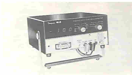
Fig. 23 - Comoda e razionale distribuzione dei comandi e dei raccordi sul nuovo multimetro digitale Simpson Modello 460 dB.
