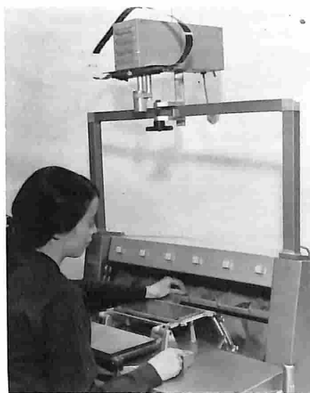
Fig. 1 - Macchina per il montaggio automatico di basette a circuiti stampati, di produzione Elite.
