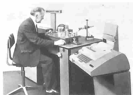
Fig. 9 - Tavolo di metrologia munito di terminali di stampaggio, prodotto dalla Teletrak.
