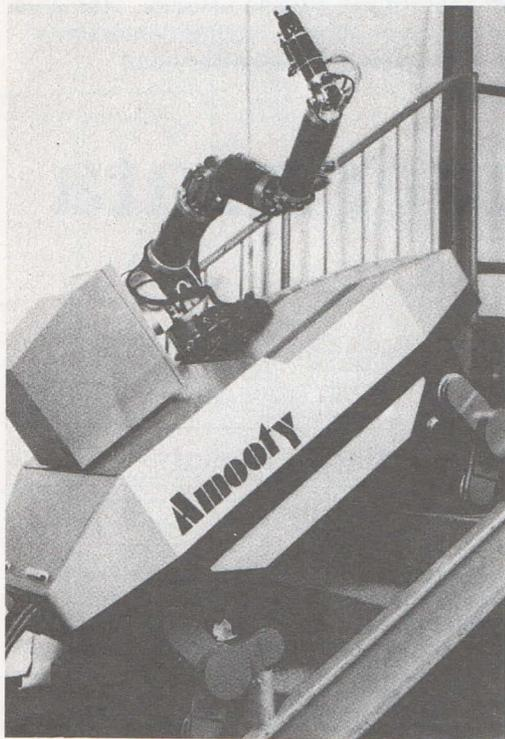
Foto 2. Su per le scale. L'Amooty della Toshiba impiega quattro gruppi locomotori con gambe a tre razze, che servono a salire e scendere le scale. La guida avviene tramite un controllo a microcomputer accoppiato con un sistema ottico a laser/TV.
