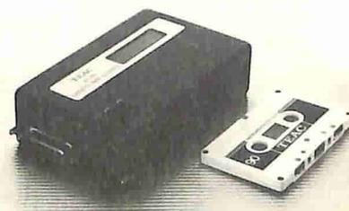
Le cassette registrate dal mod. HR-10 sono pienamente compatibili con il registratore/riproduttore TEAC MR-10, mentre quelle registrate dal mod. HR-30 sono compatibili con i registratori/riproduttori TEAC MR-30, R-71, R-81. Le altre caratteristiche principali sono: alimentazione a batteria a 9 V (12 ore di registrazione continua), peso di 580 g, canale di "noise compensation" selezionabile, canale di "meno" selezionabile, range di ingresso selezionabili di ± 0,1, 1 e 10 V.
