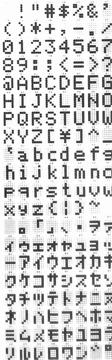
Figura 9. Tutti i caratteri disponibili sulla Mini Printer. Al di sopra dei caratteri è mostrato il codice esadecimale per coloro i quali, oltre ai simboli della matrice a punti ed alle stampe multiple, desiderano anche far uso di simboli grafici.
