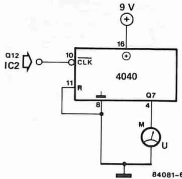
Figura 6. Questo circuito permetterà di mettere a punto l'oscillatore. Quando sarà correttamente collegato al flash meter, questo integrato 4040 farà deflettere l'indice del multimetro esattamente 8 secondi dopo che il flash meter è stato avviato (se la frequenza dell'oscillatore è giusta).
