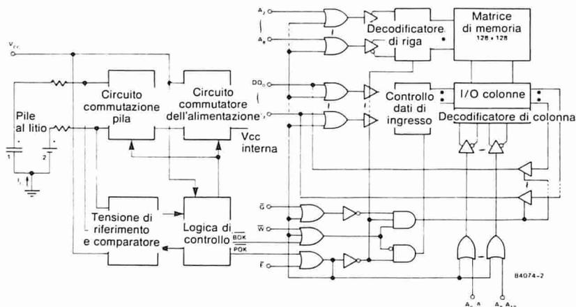
Figura 2. In questo schema possono essere facilmente riconosciute le funzioni della RAM/EPROM.
