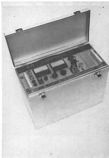
Il set comprende anche il cavo coassiale alta tensione per il collegamento al cavo da provare, un dispositivo automatico di scarica, un temporizzatore da 0 a 30 minuti e un'uscita per l'eventuale registrazione della corrente erogata dal generatore durante la prova.
