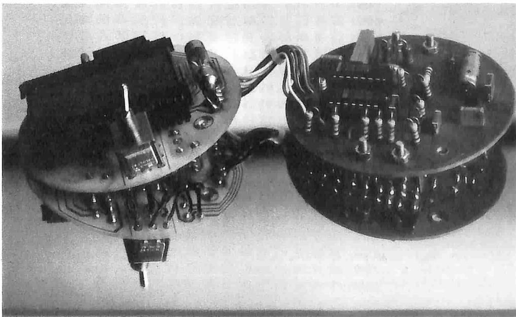
Figura 5. Questo circuito potrà essere usato per tarare il contagiri. Il suo scopo è quello di simulare gli impulsi delle puntine platinite (a 50 Hz) normalmente applicati nel punto A del circuito, con un motore ruotante a 1500 giri al minuto.
