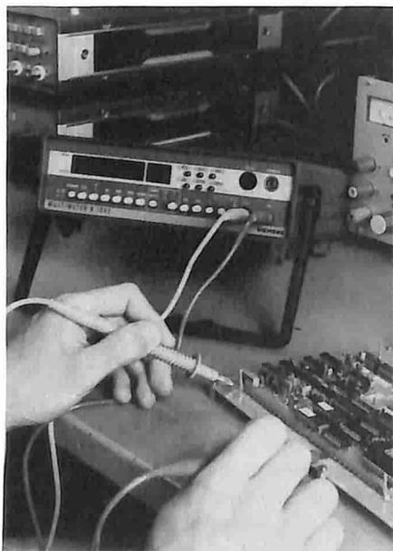
L'apparecchio, compatto e con custodia da tavolo (secondo IEC 625), può essere telecomandato da un controller bus IEC ed è perciò adatto anche all'elaborazione automatica dei valori di misura nei posti di misura a bus IEC.
