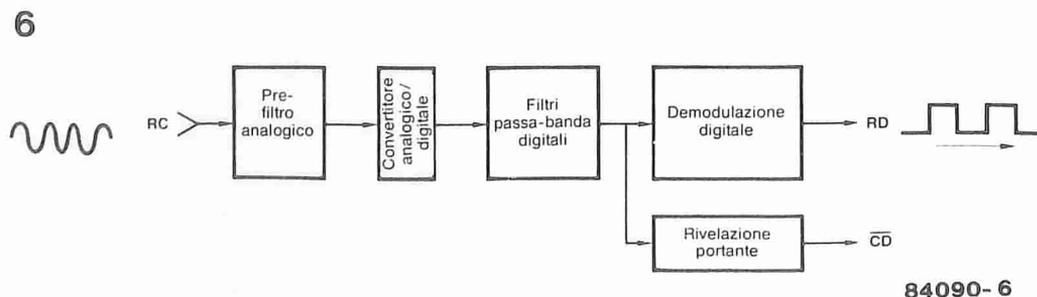
Figura 6. Le diverse sottosezioni che compongono la sezione ricevente.
