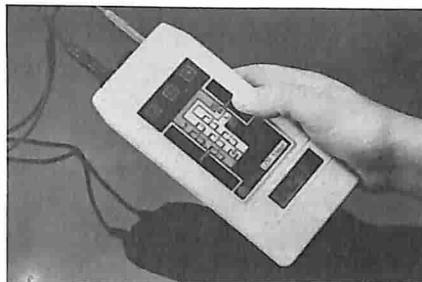
in 7 portate da 20  $\Omega$  a 20 M  $\Omega$  e la capacità in 7 portate da 200 pF a 200  $\mu$ F.
