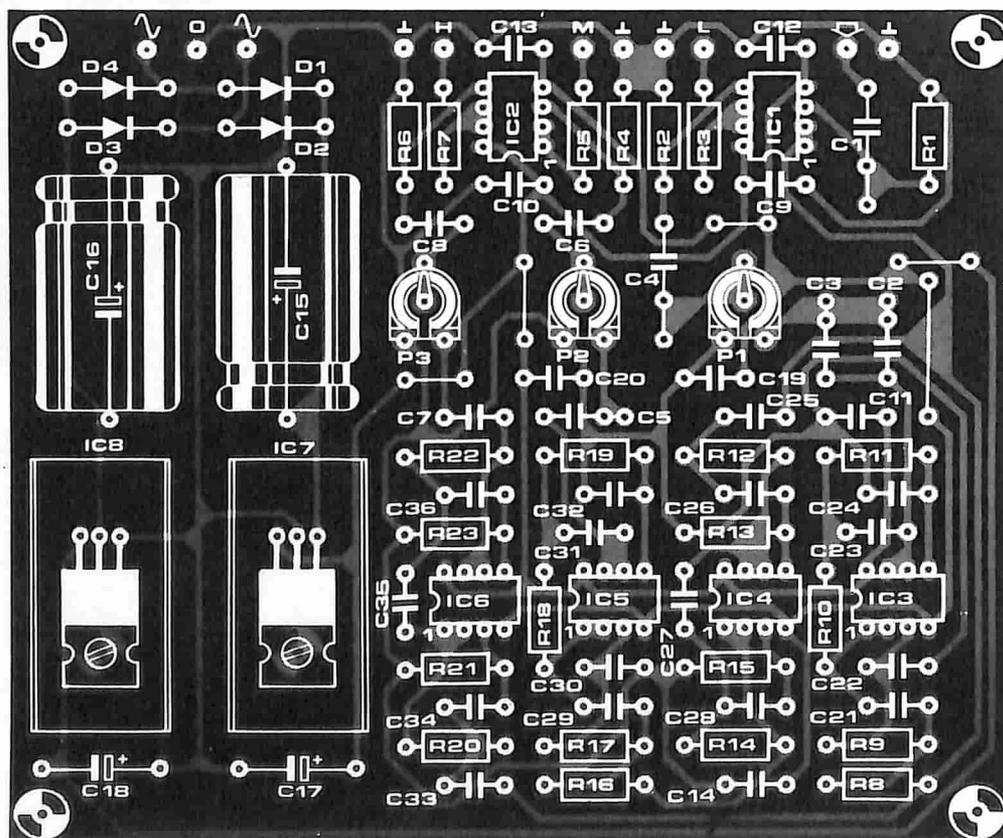
**Figura 7. Tutti i diversi tipi e le combinazioni dei filtri descritti nel testo possono essere realizzati usando questo circuito stampato.**
