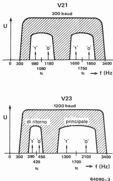
Figura 3. Le onde portanti usate nel modo V21 (a) e nel modo V23 (b) devono essere comprese entro la larghezza di banda usata dal sistema telefonico.
