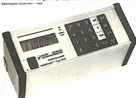
quindi adatto alla calibrazione di registratori, strumenti da processo, termocoppie, strumenti di misura digitali ed altri, sia in laboratorio che sul campo, grazie anche al fatto che il 4405 consente l'alimentazione a 220 V e a batterie al NiCd ricaricabili incorporate.
