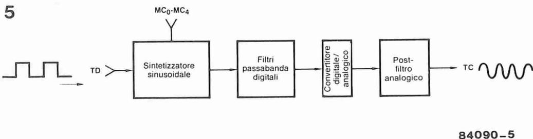
Figura 5. Maggiori dettagli della sezione trasmittente del modem.
