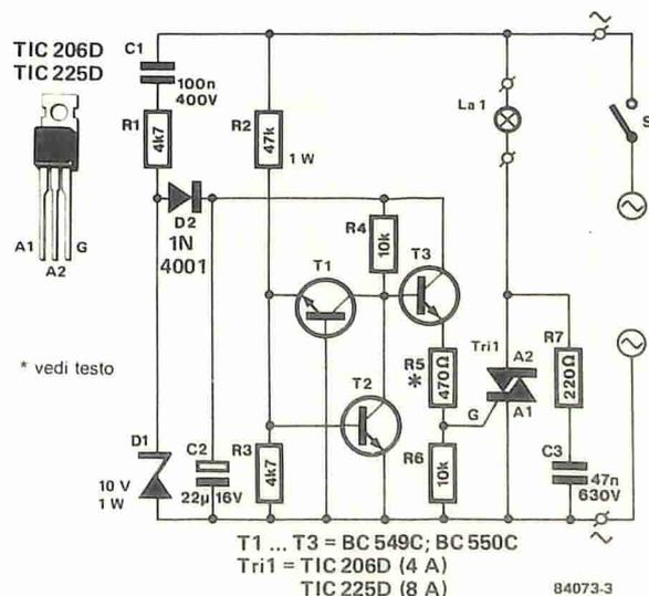
un segnale c.c., e perciò la corrente di gate, commuta alternativamente tra valori positivi e negativi, così che è necessario un transistor PNP per condurre la corrente di gate negativa. Lo svantaggio di questa versione del circuito è che ci deve essere sempre un certo assorbimento di corrente, ma in confronto ai normali valori della corrente assorbita da apparecchiature alimentate da rete, questa corrente sarà trascurabile.
