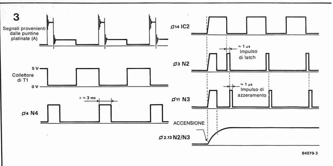
Figura 3. Questo diagramma di temporizzazione, come già spiegato nel testo, è diviso in due parti, che devono essere considerate come se fossero separate, in quanto le loro basi dei tempi sono completamente diverse.
