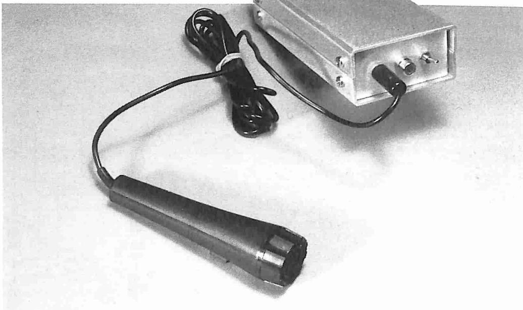
Per fugare ogni possibile dubbio, cominciamo col mettere in evidenza che il progetto qui pubblicato ha poco in comune con i "microfoni senza filo" che si trovano qualche volta in vendita. In realtà, questo progetto può sostituire un vero microfono professionale senza fili. Il suo trasmettitore in miniatura permette di ottenere un suono di ottima qualità. Il ricevitore è semplicemente una versione modificata del "Personal FM" pubblicato nel numero di Elektor del gennaio 1984.
