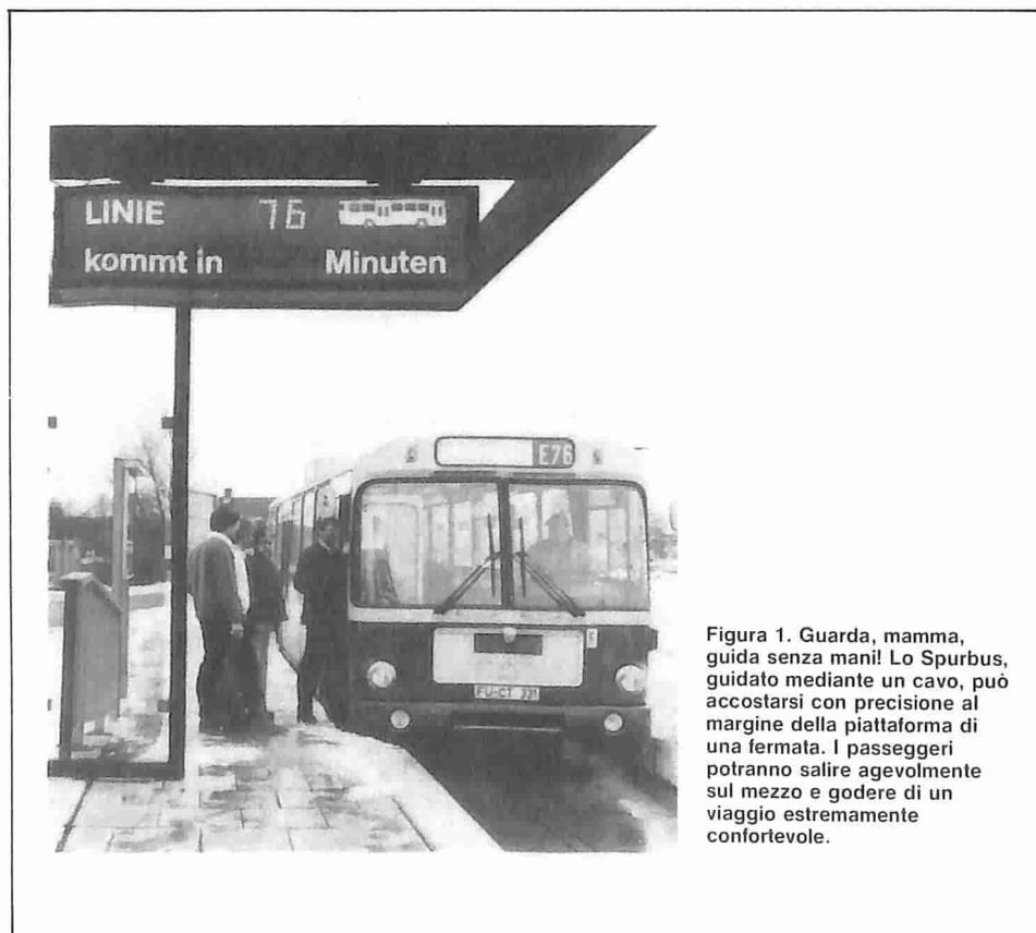
Figura 1. Guarda, mamma, guida senza mani! Lo Spurbus, guidato mediante un cavo, può accostarsi con precisione al margine della piattaforma di una fermata. I passeggeri potranno salire agevolmente sul mezzo e godere di un viaggio estremamente confortevole.
