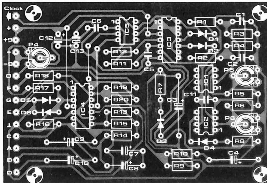
Figura 6. Piste di rame e disposizione dei componenti del circuito stampato per gli stadi oscillatore e di controllo.
