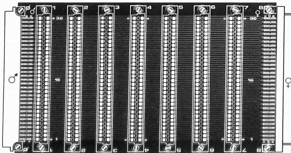
Figura 1. Come montare i connettori. Particolare attenzione deve essere dedicata ai due connettori terminali.
