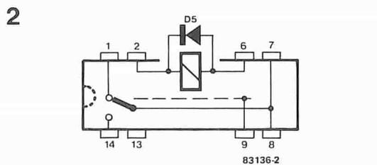
Figura 2. Componenti interni e disposizione dei piedini del relè reed. Nonostante la loro piccola dimensione, molti relè miniatura hanno un diodo integrato.
