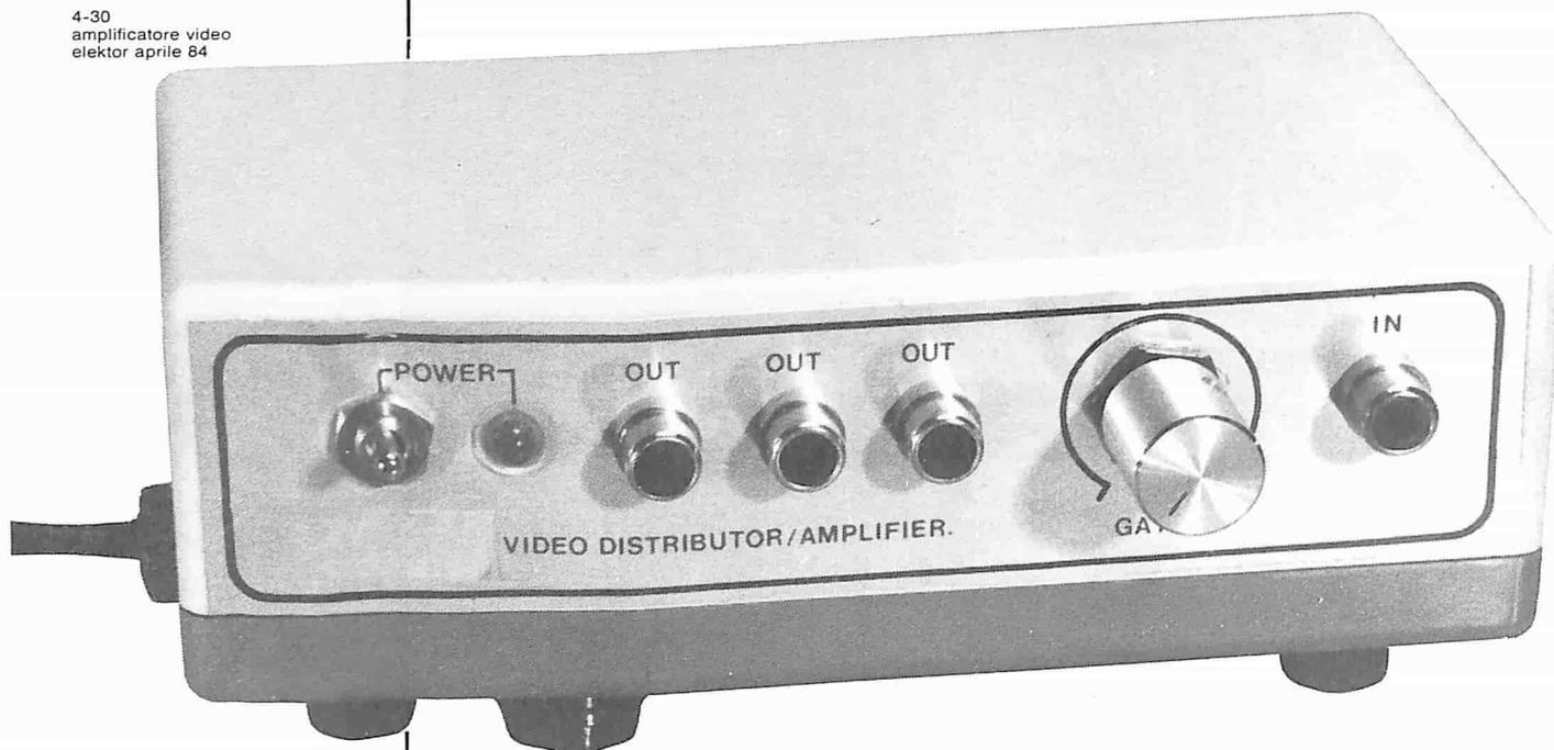
In quasi tutte le catene video molto estese è gradita una certa amplificazione in più. Intendiamo, per esempio, la compensazione delle perdite nei cavi, il rafforzamento del segnale proveniente da un ingresso non molto sensibile, od altre applicazioni nelle quali i segnali debbano essere sintonizzati l'uno con l'altro. Questo semplice amplificatore è ideale per tutte le suddette applicazioni. Esso funziona inoltre da distributore, in quanto la versione standard è equipaggiata con tre uscite.
