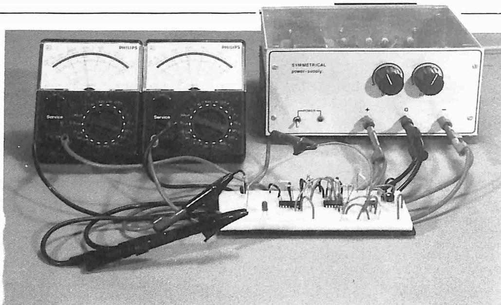
Chiunque si intenda un poco di elettronica sa che un alimentatore simmetrico è praticamente indispensabile per poter realizzare esperimenti con amplificatori operazionali o per collaudare i circuiti nei quali essi siano montati. L'alimentatore descritto in questo articolo fornisce due tensioni IDENTICHE di precisione, che possono essere regolate mediante un unico potenziometro ed ha un circuito limitatore di corrente REGOLABILE.
