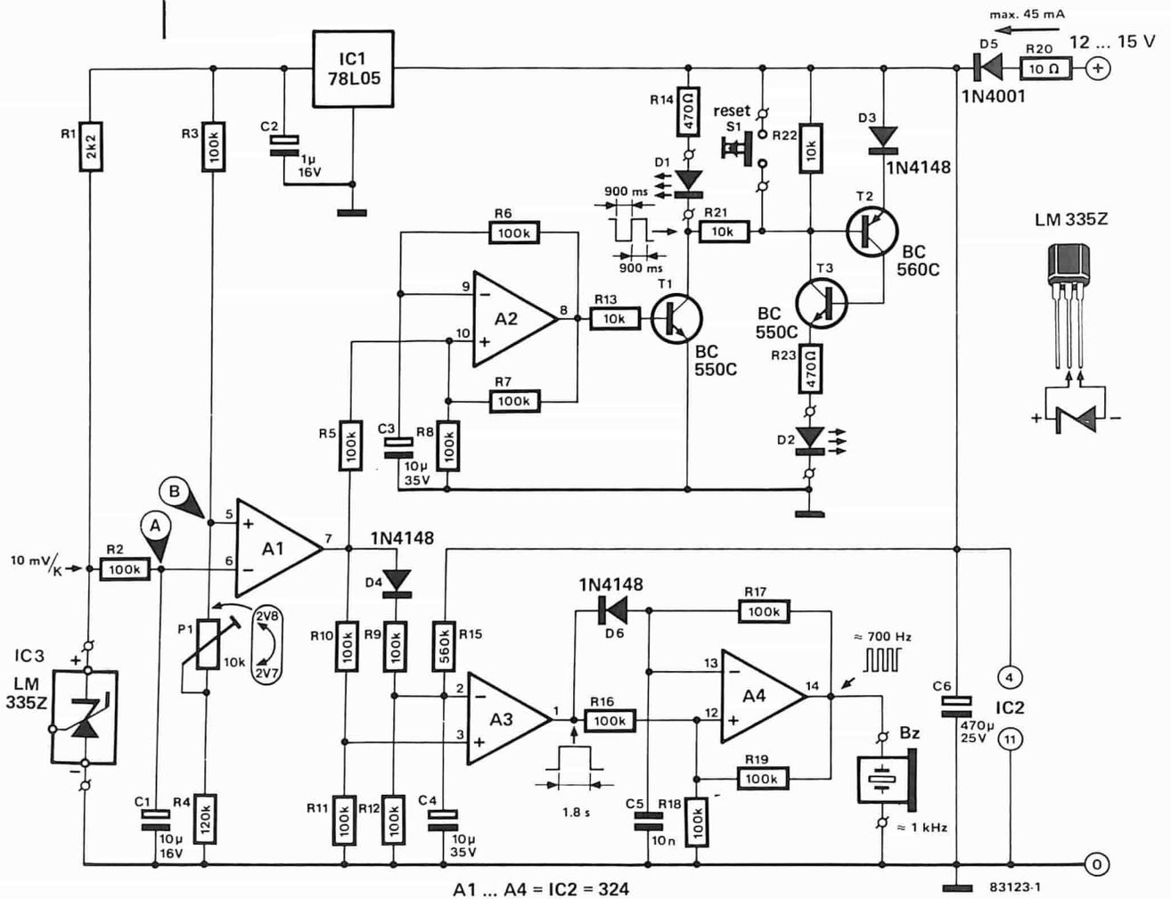
Figura 1. Schema elettrico dell'avvisatore di gelo. Quando la temperatura rilevata dall'LM 335Z scende al di sotto di un livello predisposto, la condizione viene segnalata dai due LED e dal cicalino.
