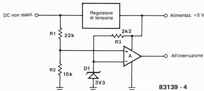
Figura 4. Questo circuito serve a rilevare le mancanze di alimentazione, nel qual caso invia un impulso STORE (negato) alla NOVRAM.
