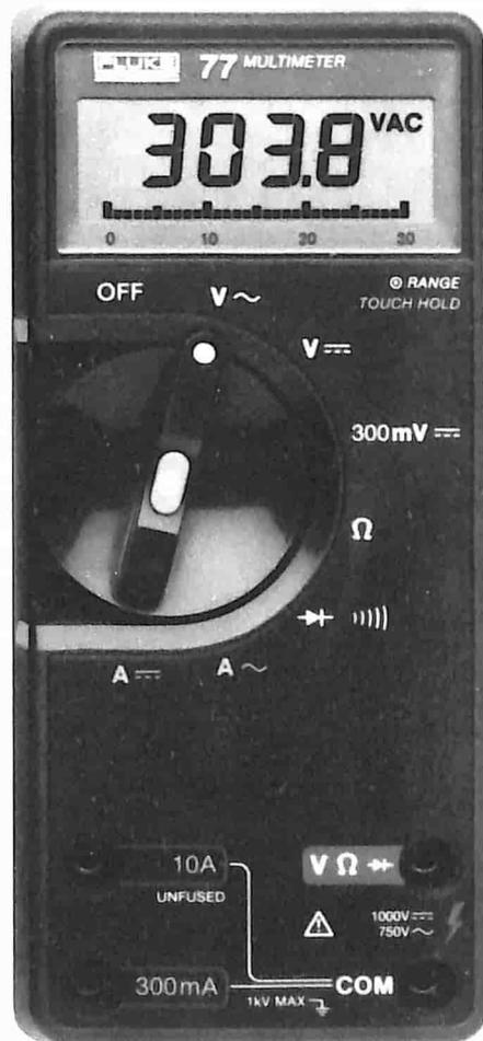
Il display digitale consente di effettuare letture precise con una risoluzione elevata. La barra grafica analogica è invece adatta a rivelare le variazioni e la tendenza delle varie grandezze. La selezione della gamma può essere manuale oppure automatica.
