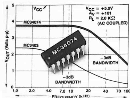
Essi offrono prestazioni migliorate sia in larghezza di banda che slew rate. La tecnologia bipolare standard, accoppiata a innovativi concetti di progettazione che comprendono un ingresso "pole-zero cancellation" e compensazione "Miller loop" a tutte le uscite NPN, fornisce un prodotto guadagno-frequenza di 4,5 MHz ed un valore di slew rate pari a 13 V/ $\mu$ s senza fare uso della tecnologia JFET a canale P.
