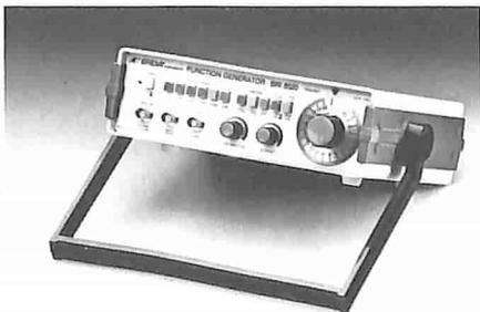
Gli apparecchi hanno impedenza di uscita di 50  $\Omega$  e sono provvisti di una uscita addizionale che fornisce un segnale a livello TTL con un fan-out di 20 carichi standard. La possibilità di sweep permette un rapporto di frequenza 1000:1. Esiste inoltre la possibilità di sovrapporre al segnale d'uscita un livello continuo regolabile in ampiezza.
