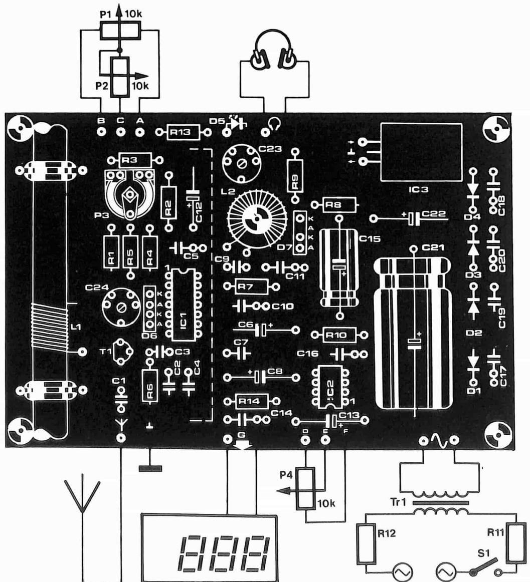
Figura 4. Il circuito stampato è del tipo a doppia faccia ramata. Lo strato di rame sul lato componenti funziona come piano di massa.
