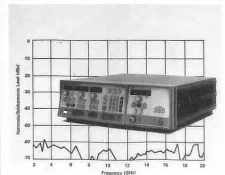
Grazie all'accordo del filtro con l'oscillatore a microonde, la perdita di inserzione è minimizzata e in questo modo il livello di uscita è  $+6 \text{ dBm}$  da 2 a  $18,6 \text{ GHz}$  e  $+4 \text{ dBm}$  a  $20 \text{ GHz}$  (il livello da  $10 \text{ MHz}$  a  $2 \text{ GHz}$  è  $+10 \text{ dBm}$ ).
