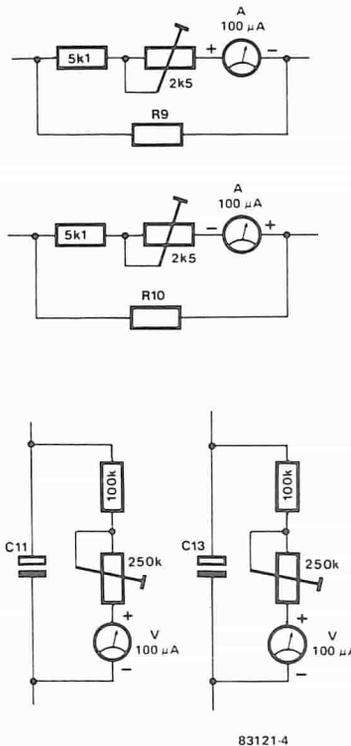
Figura 4. Montaggio facoltativo degli strumenti sull'alimentatore. Questi strumenti permettono la lettura diretta delle tensioni d'uscita e delle correnti nel carico.
