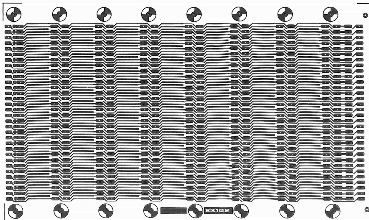
Poiché sono disponibili due tipi di connettori femmina angolati, uno con il passo tra le file di 2,5 mm e l'altro con passo di 5 mm, abbiamo progettato il circuito stampato in modo che sia compatibile sia con il tipo "a + b" che con il tipo "a + c".
