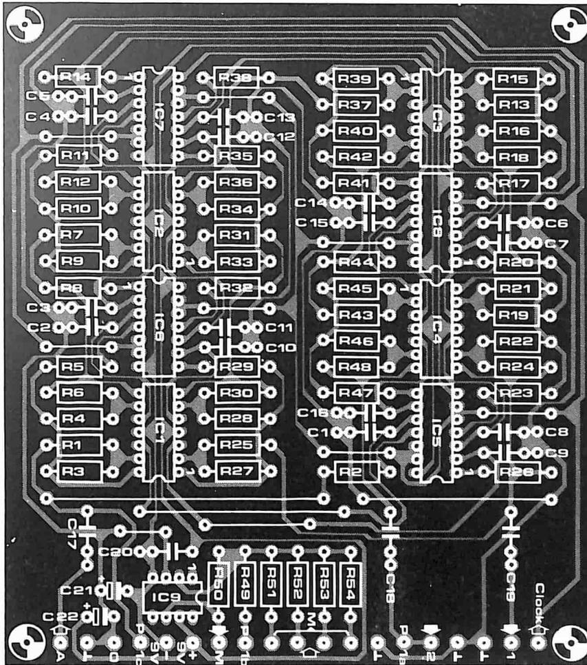
Figura 5. Piste di rame e disposizione dei componenti sul circuito stampato della linea di ritardo: sono stati previsti i punti di montaggio per le resistenze R51...R54.
