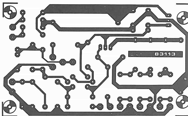
Figura 2. Il circuito stampato contiene sia l'amplificatore che l'alimentatore. Solo il trasformatore di rete non è montato sul circuito stampato.
