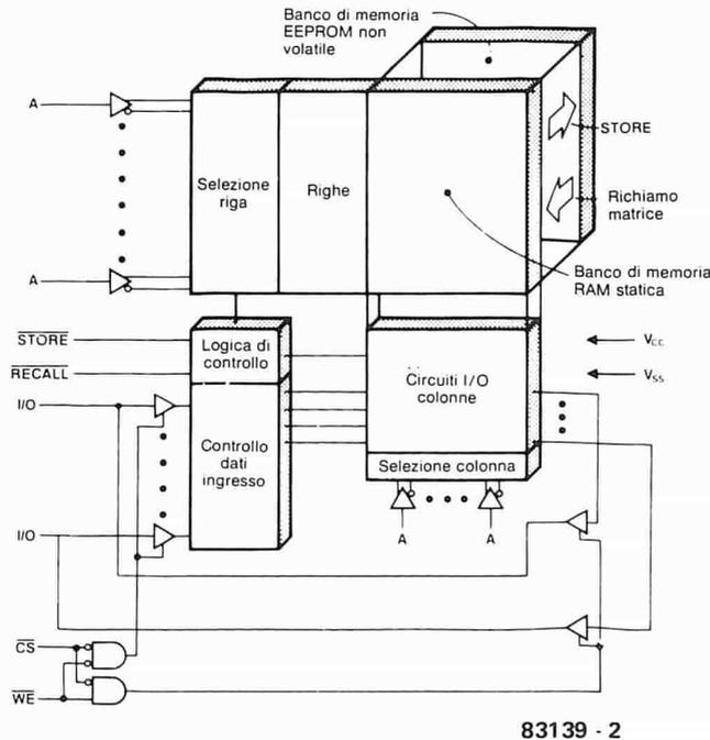
Figura 2. Questo schema a blocchi mostra la composizione della NOVRAM. La sezione di memoria è duplice, in quanto consiste di sezioni RAM e di sezioni EEPROM.
