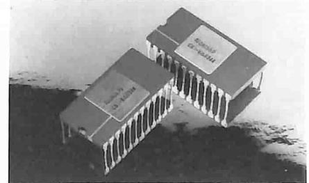
I principali vantaggi offerti da questi dispositivi monolitici sono un consumo massimo di 450 mW, il funzionamento senza l'alimentazione a +5 V, con alimentazioni sia a  $\pm 12$  V che a  $\pm 15$  V.
