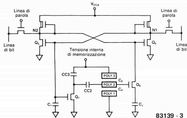
Figura 3. Schema di una singola cella di memoria. La sezione RAM è rappresentata nella parte superiore dello schema, mentre la zona inferiore è la cella EEPROM.
