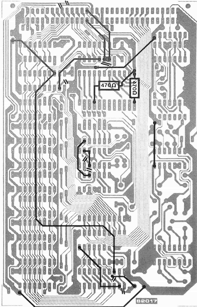
Figura 3. Questo disegno delle piste di rame del circuito stampato mostra chiaramente quali siano le piste da interrompere ed i nuovi collegamenti da effettuare. Osservare che alcune linee di massa sono troppo strette e perciò dovranno essere rinforzate. Infine, non dimenticate di togliere il ponticello che si trova a lato di IC9.
