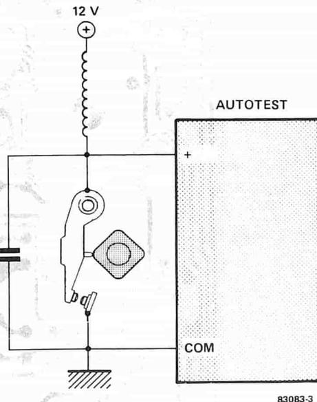
Figura 3. "Schema elettrico" del sistema primario di accensione, che è composto dal ruttore, dalla bobina e da un condensatore.
