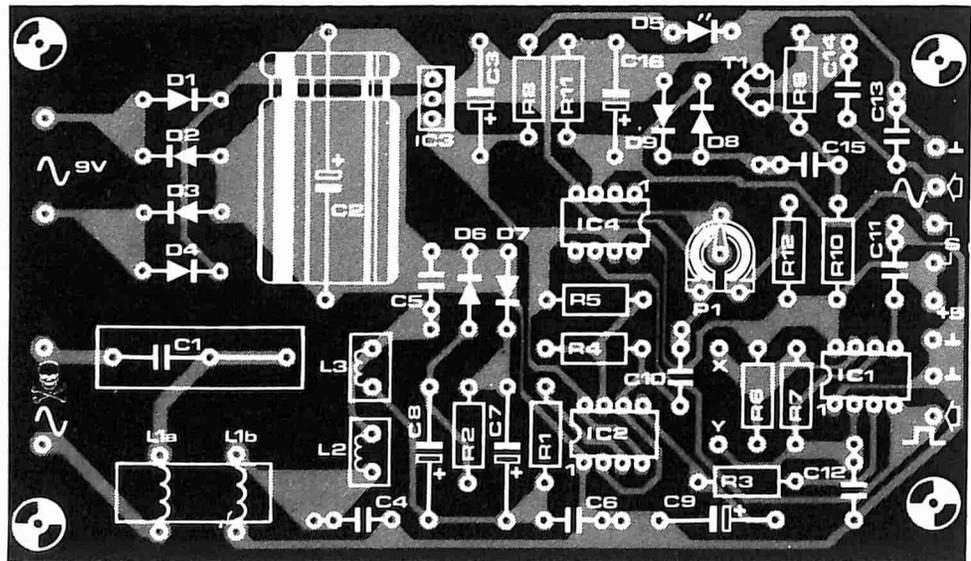
Ciascun trasformatore L1 verrà costruito avvolgendo 10 spire uniformemente spaziate su un nucleo toroidale del tipo usato per la soppressione dei disturbi nei dimmer a triac. Usare per l'avvolgimento filo di rame smaltato diametro 1,3 mm oppure, ancora meglio, una trecciola isolata. L'avvolgimento supplementare sarà collegato alla tensione di rete, perciò sarà necessario usare le consuete precauzioni!
