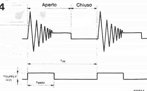
Figura 4. Forma d'onda che verrà probabilmente rilevata ai contatti del ruttore. Sono necessarie alcune modifiche prima che sia possibile usarla per la misura.
