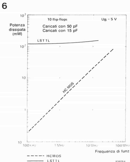
Figura 6. In un circuito più complesso, che comprenda una catena di 10 flip flop, la potenza dissipata dagli HCMOS è chiaramente molto inferiore a quella degli LSTTL, anche alle massime frequenze di funzionamento.
