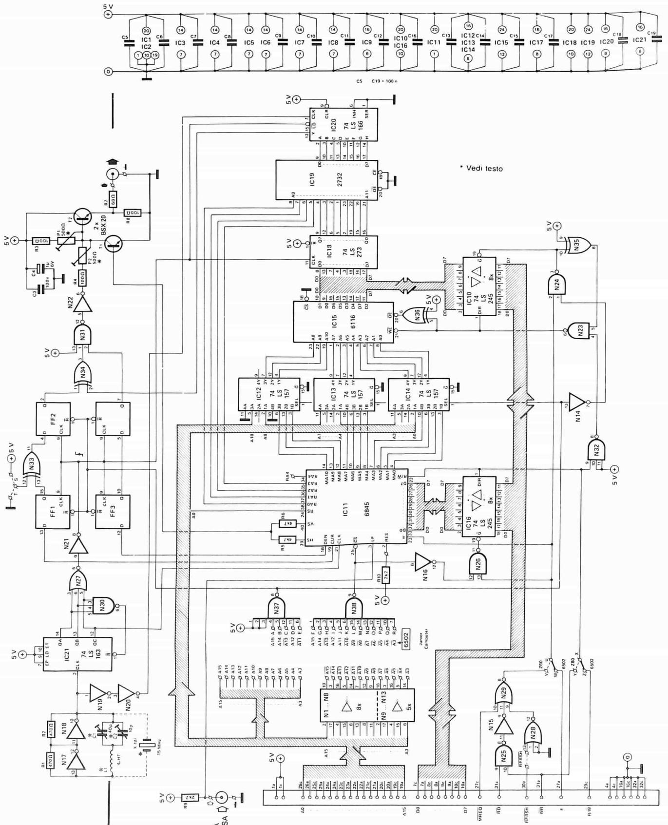
Figura 4. Schema elettrico della scheda VDU. I componenti più importanti sono: IC11 (unità di controllo video), IC15 (RAM video) ed IC19 (generatore di caratteri).
