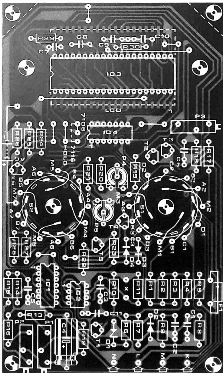
Figura 6. Tutti i componenti dell'Autotest (eccettuato lo shunt da 20 A) sono montati su questo circuito stampato. Il display a cristalli liquidi dovrà essere montato sul lato delle piste di rame. Si raccomanda di usare per il montaggio del display i contatti a lista senza supporto.
