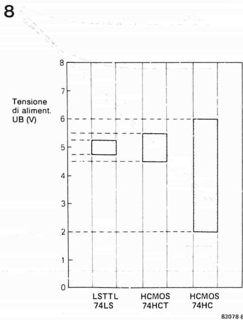
Figura 8. La variazione ammessa della tensione di alimentazione è di  $\pm 10\%$  nella serie 74HCT (compatibile con i circuiti TTL), cioè doppia di quella permessa con gli LSTTL. La serie 74HC può funzionare con tensioni minime di alimentazione di 2 V.
