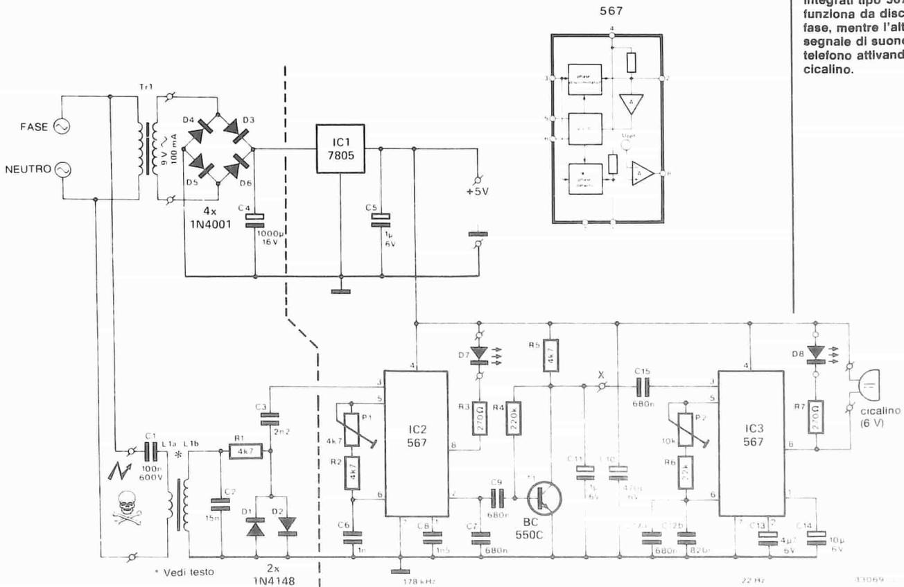
Figura 3. Lo schema del ricevitore mostra che sono sufficienti solo due circuiti integrati tipo 567. Uno di questi funziona da discriminatore di fase, mentre l'altro "rileva" il segnale di suoneria del telefono attivando il LED ed il cicalino.
