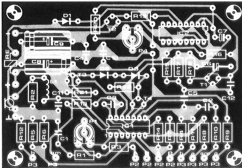
Figura 2. Piste di rame e disposizione dei componenti sul circuito stampato del VOX.
