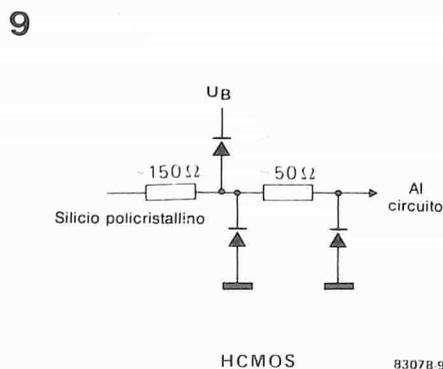
Figura 9. Questa figura mostra il reale miglioramento introdotto negli HCMOS per la protezione degli ingressi contro le scariche elettrostatiche, rispetto al sistema adottato per i CMOS.
