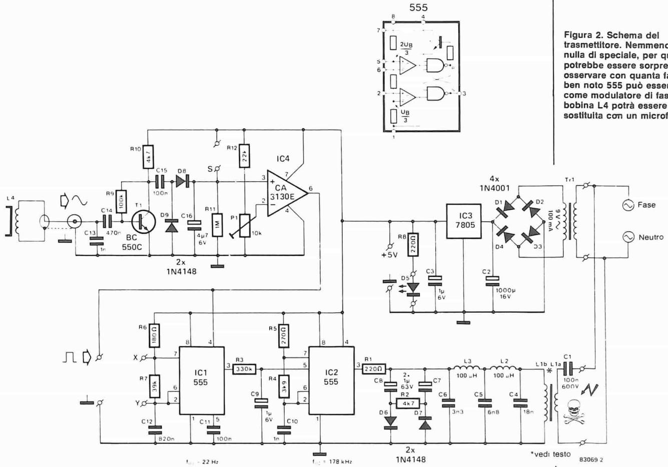
Figura 2. Schema del trasmettitore. Nemmeno qui c'è nulla di speciale, per quanto potrebbe essere sorprendente osservare con quanta facilità il ben noto 555 può essere usato come modulatore di fase. La bobina L4 potrà essere sostituita con un microfono.
