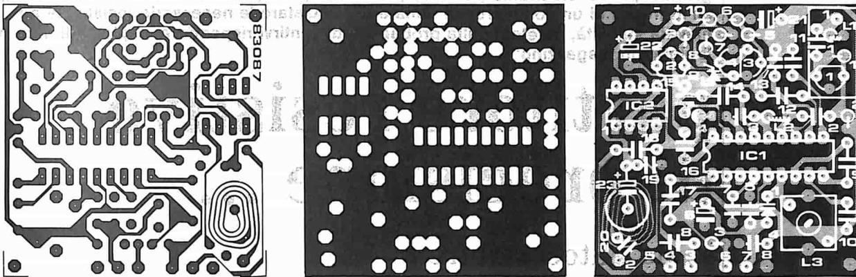
Figura 3. Disposizione dei componenti e circuito stampato a doppia faccia. La vasta area ramata sulla faccia superiore forma un piano di massa per il circuito.
