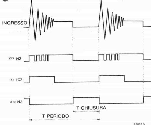
Figura 5. Forme d'onda di temporizzazione presenti nel circuito di misura dell'angolo di chiusura.
