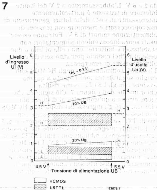
Figura 7. Questo diagramma dimostra che l'immunità ai disturbi degli HCMOS è molto superiore a quella degli LSTTL.
