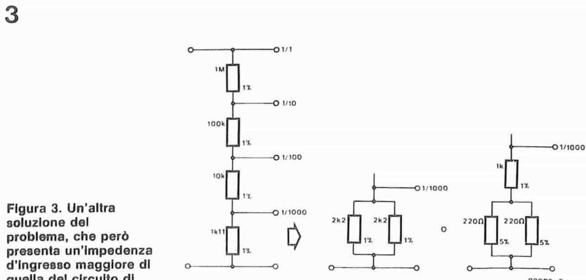
**Figura 3.** Un'altra soluzione del problema, che però presenta un'impedenza d'ingresso maggiore di quella del circuito di figura 2.
