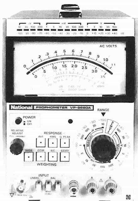
L'ingresso può essere bilanciato (da  $600 \Omega$  a  $100 \text{ k}\Omega$ ) e sbilanciato; lo strumento è completo di controllo a distanza e di uscita della misura AC e DC e può quindi essere impiegato come amplificatore.
