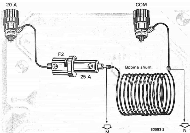
Figura 2. L'esattezza della portata di corrente dipende moltissimo dalla precisione con la quale è stato costruito lo shunt da 20 A.
