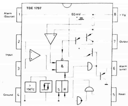
Il TDE 1797 funziona con un'alimentazione di  $\pm 15 \text{ V}$  o con una tensione mono da  $+6$  a  $+35 \text{ V}$ .
