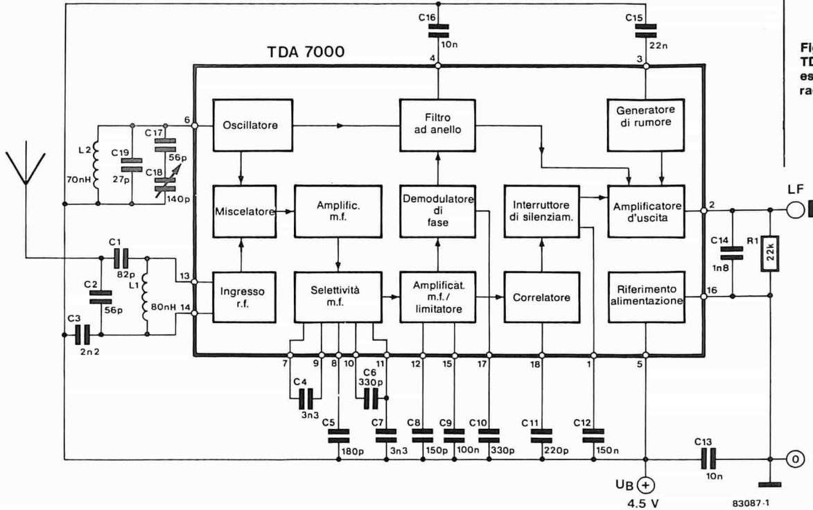
Figura 1. Schema a blocchi del TDA 7000, con i componenti esterni necessari per il radiorecettore elementare.
