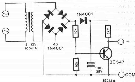
Figura 8. Questo piccolo circuito ausiliario di prova viene impiegato per tarare la portata di misura dei giri al minuto. Potrà essere montato su una piccola plastrina.
