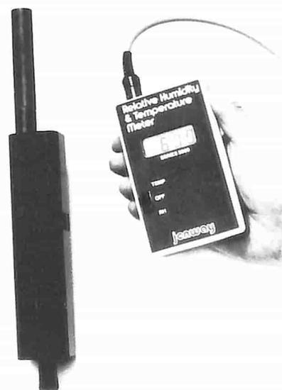
Lo strumento utilizza la tecnica dello psicrometro e cioè di convogliare l'aria a mezzo di una ventola verso due sensori di alta precisione, uno dei quali misura l'aria asciutta (bulbo asciutto) e l'altro misura la temperatura umida (bulbo umido).
