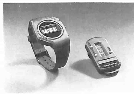
Il cardiotachimetro permette di misurare la frequenza del polso mediante sensori a raggi infrarossi che riflettono il flusso sanguigno all'interno delle vene di chi lo indossa. La misura offre un grado di precisione di circa  $\pm 1,25\%$ .
