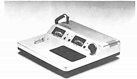
Un registratore di risonanza controlla la frequenza del risonatore al quarzo mediante un sistema ad ultrasuoni e fa una verifica di precisione da assoluto a  $\pm 10$  secondi al giorno. Verifica anche la stabilità del motore passo-passo del movimento identificandone il tono.
