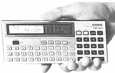
Il microelaboratore LSI ad un solo chip a basso consumo adottato comprende ben 150.000 elementi.
