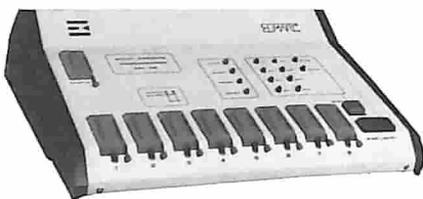
Le altre caratteristiche sono un riferimento interno di precisione, 6 range di tensione di ingresso unipolare e bipolare pin programmabili, e uscita dei dati sia parallela che seriale.
