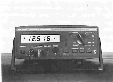
La funzione dB con lo zero relativo permette di misurare direttamente guadagni e perdite sino a  $\pm 98$  dB.
