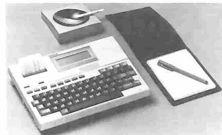
Un set completo di porte seriali, un'interfaccia RS 232C ed altre interfacce per lettore ottico di codici a barre, per audio cassetta e per un system bus esterno permettono una maggiore espansione di memoria e di capacità di archiviazione dati.
