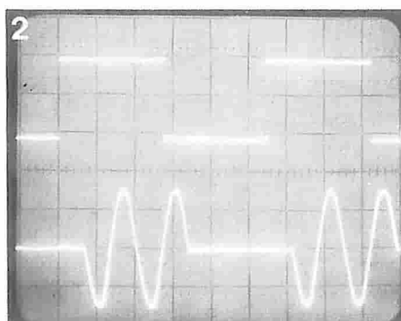
Foto 2. La tensione al carico.
