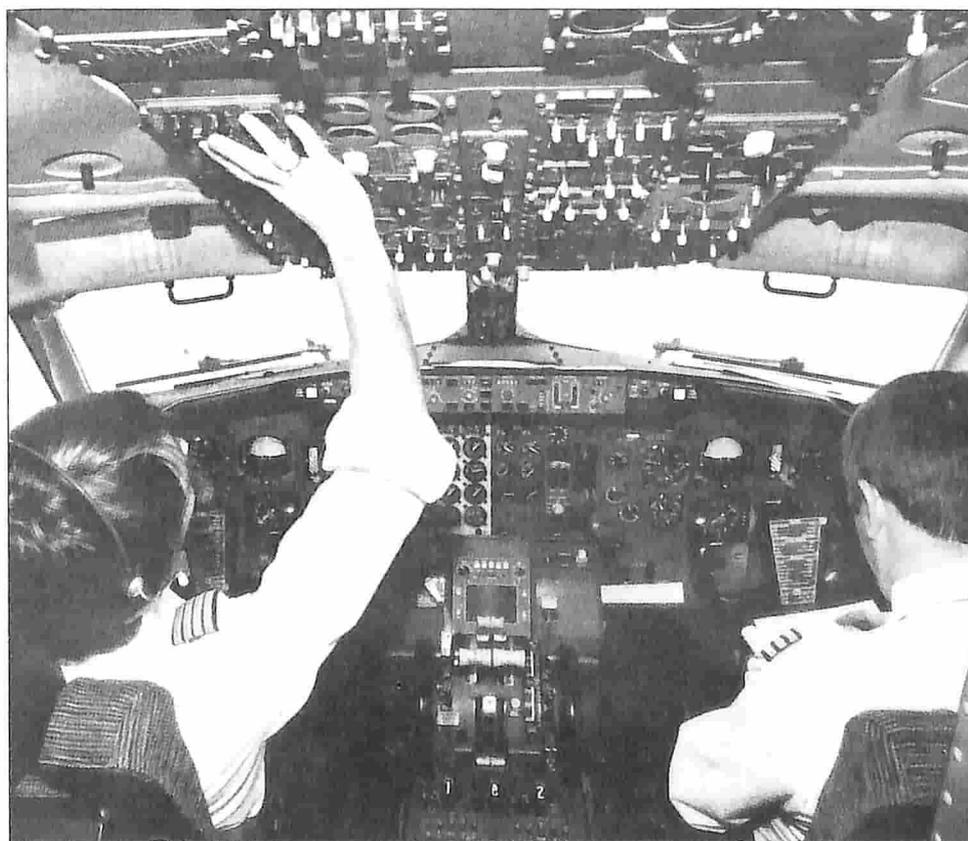
Figura 2. Il posto di lavoro del pilota e del copilota: tutti gli apparecchi di servizio sono a portata di mano e sono disposti secondo un ordine logico.
