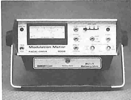
Senza effettuare alcuna sintonia manuale e senza dover predisporre i valori dei livelli, si possono misurare segnali nella banda di frequenza da 1,5 MHz a 2 GHz, con 8 range FM con valori di fondo scala della deviazione di picco da 1,5 kHz a 100 kHz e 6 range AM con valori di profondità di modulazione dal 5% al 100%. Lo strumento, che è programmabile a distanza, può funzionare sia a rete che a batteria.
