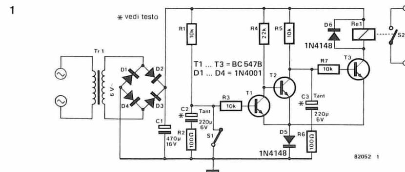
tuazione, il condensatore C2 si caricherà tramite la resistenza R1 e provocherà eventualmente il cambio di stato del trigger di Schmitt formato dai transistori T1 e T2. A questo punto inizierà a caricarsi il condensatore C3, e ci sarà un ulteriore ritardo prima che possa passare in conduzione il transistor T3, che a sua volta ecciterà il relé. I contatti del relé (S2) saranno usati per azionare la "voce", ossia il campanello, il cicalino eccetera.
