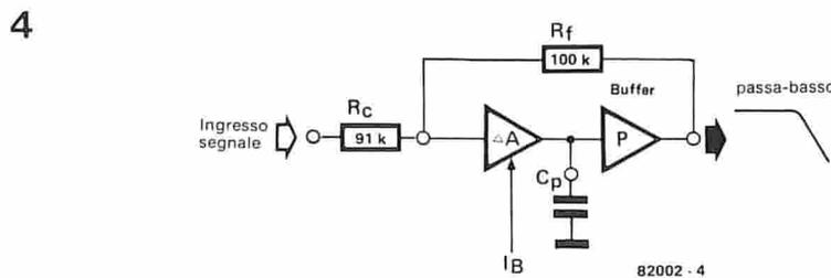
Figura 4. Uno stadio di filtro collegato come passa-basso con una pendenza di 6 dB per ottava e guadagno unitario nella banda passante.
