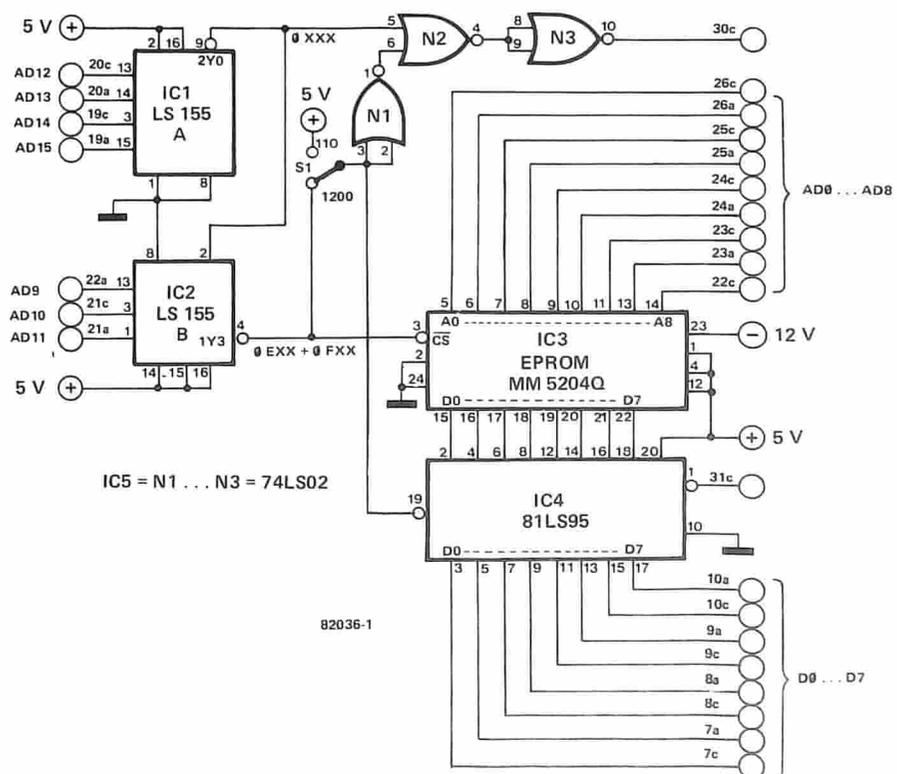
Figura 1. Lo schema elettrico del circuito addizionale NIBL 1200 GT. IC1 è il decodificatore degli indirizzi che prima si trovava sulla scheda del microcomputer BASIC.
