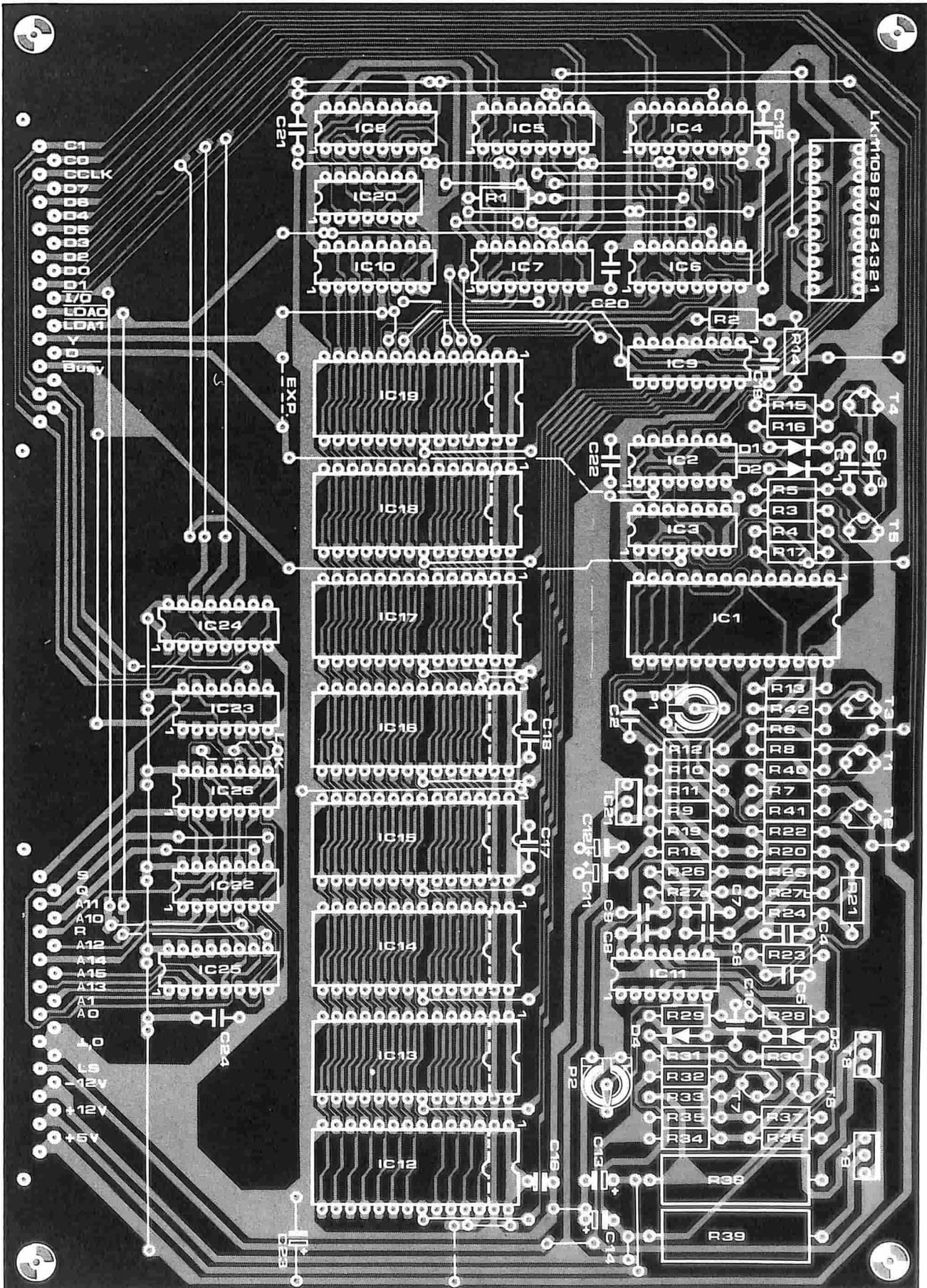
Figura 7. La disposizione dei componenti della scheda parlante.
