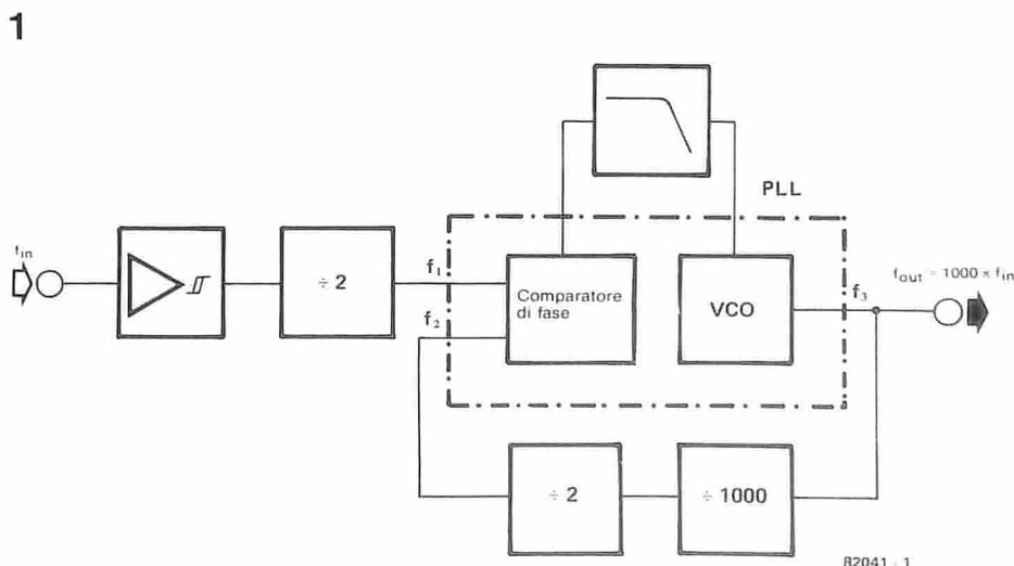
Figura 1. Lo schema a blocchi del moltiplicatore di frequenza mostra che la parte più importante del circuito è un PLL (Phase Locked Loop = anello ad aggancio di fase).
