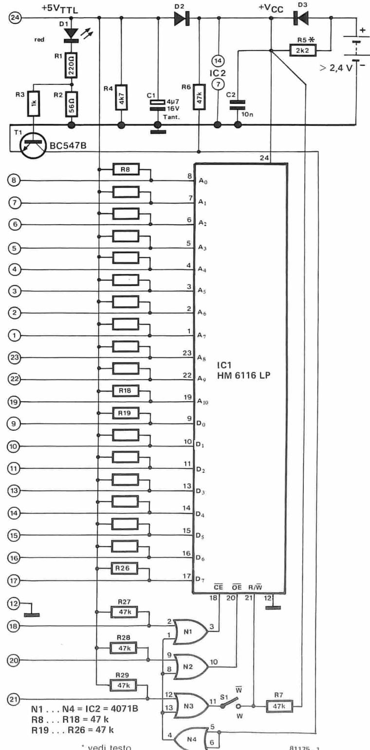
Figura 1. Lo schema completo della IPROM. Quando si spegne l'alimentazione del computer, entrano in azione le batterie. I numeri dentro un circoletto si riferiscono alla numerazione dei piedini dello zoccolo entro il quale si dovrà inserire la IPROM.
