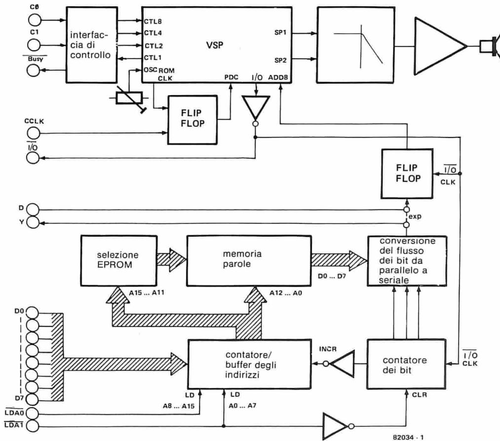
Figura 1. Lo schema a blocchi della "scheda parlante".
