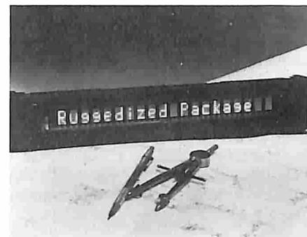
Particolarmente resistente agli urti, anche questo display è dotato di un controller a microprocessore on-board, ha le funzioni controllate con software, ha un'interfaccia data bus a 8 bit e richiede una alimentazione singola a 5 V.
