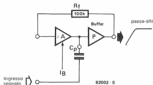
Figura 5. Un filtro passa-alto a 6 dB per ottava, sempre con guadagno unitario entro la banda passante.
