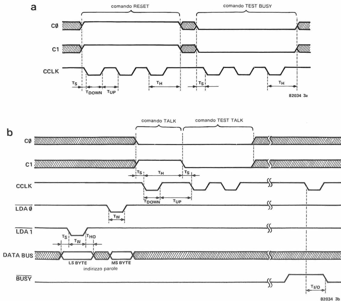
Figura 3. I segnali di controllo devono essere in accordo con determinati requisiti di temporizzazione. La figura 3a mostra la durata dei segnali durante l'inizializzazione, mentre la figura 3b mostra ciò che avviene quando la scheda "parla".
