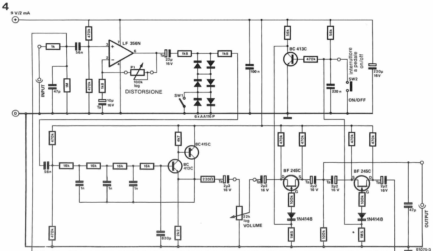
Figura 4. Questo circuito fuzz è progettato per i solisti di chitarra. La sezione fuzz vera e propria segue un filtro passabasso a sezioni, che rende la sonorità dello strumento molto più piacevole all'orecchio.
