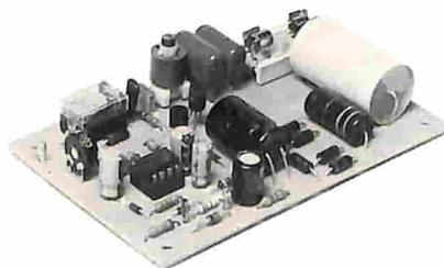
Questo dispositivo corredato da un captatore magnetico ed usato in coppia con il KS 484 permette la ripetizione di chiamate telefoniche nell'ambito domestico senza l'ausilio di antenne o fili appositi.
