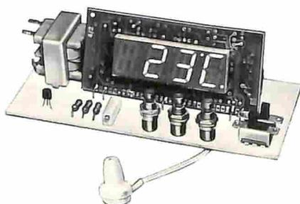
Un comodo orologio digitale ed un preciso termometro digitale con lo stesso circuito. Applicabile per svariatissimi usi: orologi da pannello, per strumenti e termometri ambiente.
