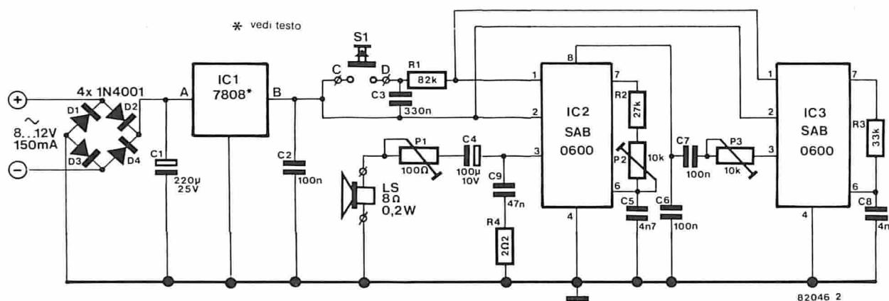
Figura 2. Lo schema elettrico completo del carillon elettronico. Questa versione "di lusso" contiene due circuiti integrati di gong. Poiché essi sono leggermente disaccordati tra loro, viene prodotto un effetto di leggero tremolo e di phasing.
