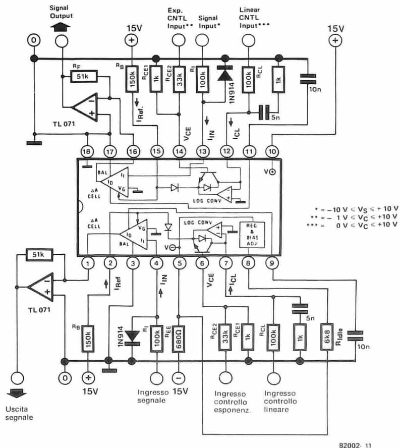
Figura 11. Lo schema elettrico del doppio VCA CEM 3330. Questo circuito integrato contiene due amplificatori controllati in tensione, che possono essere pilotati sia con legge lineare che logaritmica.
