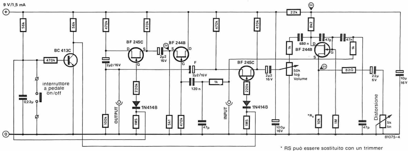
Figura 5. Dato che per l'accompagnamento si debbono osservare dei requisiti differenti, è meglio usare un circuito fuzz separato.
