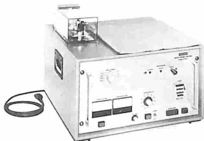
Come opzione si possono avere un interruttore di sicurezza supplementare, il comando a distanza e il trigger per l'oscilloscopio. I generatori sono adatti per il montaggio in rack da 19".
