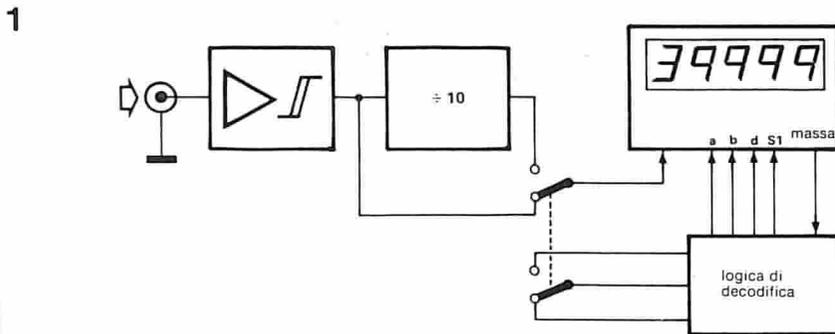
Figura 1. Lo schema a blocchi del frequenzimetro.
