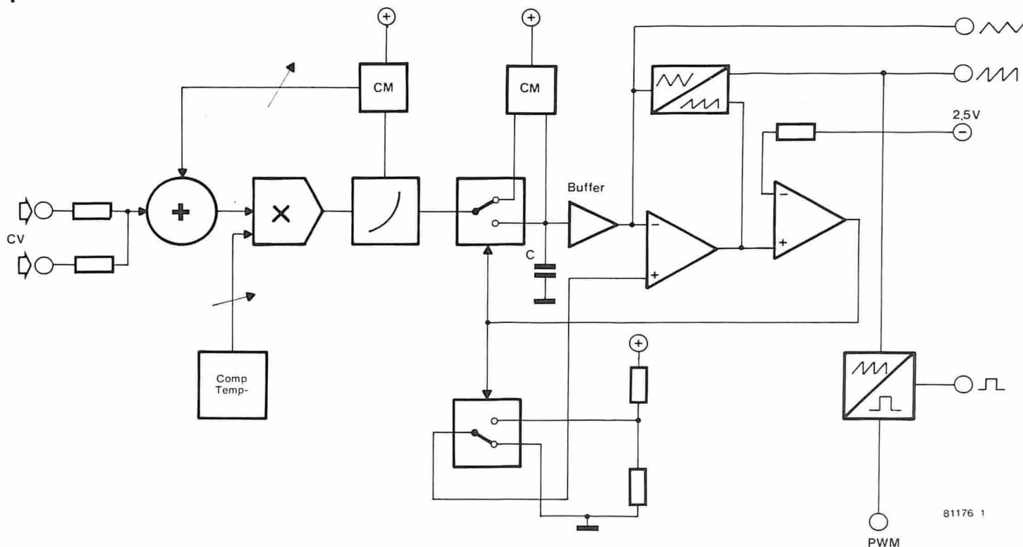
Figura 1. Lo schema a blocchi del CEM 3340. Questo integrato contiene tutti i componenti necessari per costruire un VCO per sintetizzatore esponenziale: sommatore d'ingresso, un esponenziatore compensato in temperatura, un oscillatore triangolare, un convertitore triangolo-dente di sega e dente di sega quadrato. Quest'ultimo dispone di un ingresso di controllo per la modulazione a durata d'impulso. Questo integrato è molto adatto all'impiego in generatori di funzioni wobulate di precisione.
