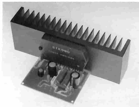
Con l'esclusiva tecnologia di costruzione gli integrati realizzati in Thick-film, unitamente a pochi componenti passivi esterni formano un dispositivo amplificatore di qualità elevata. Garantiscono: alta sensibilità d'ingresso, notevoli potenze d'uscita, frequenze di risposta molto ampie, pur mantenendo i loro valori in distorsione estremamente bassi.
