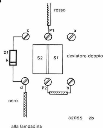
Nota: i terminali di collegamento del vostro doppio deviatore possono anche non coincidere con quelli di figura 2b. Sarebbe quindi bene controllare come stanno le cose mediante un ohmmetro, prima di cominciare a montare il circuito. ◀
