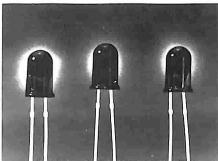
Questi indicatori sono caratterizzati da una elevata visibilità in ambienti illuminati; l'HLMP-4601 in particolare ha una intensità luminosa di 20 millicandele a 20 mA. Tale intensità, insieme alla lente diffusa, rende questi componenti ideali dove occorre avere una indicazione ad alta luminosità ed uniforme.
