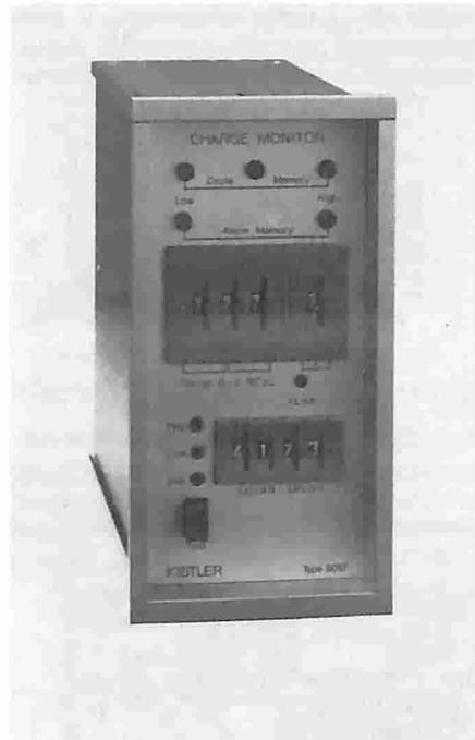
processi ciclici con misure simultanee. Le uscite di misura forniscono valori istantanei e di picco. Il range di misura e i due valori limite corrispondenti vengono impostati con uno switch digitale. Le uscite sono disponibili come segnali logici e due sono a relé.
