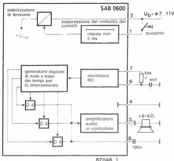
Figura 1. Lo schema a blocchi dei circuiti interni del SAB 0600. Una sequenza di note, formata da tre frequenze armoniche, potrà essere generata con un minimo numero di componenti esterni.
