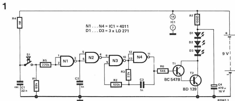
Figura 1. Lo schema elettrico del trasmettitore ad infrarossi.
