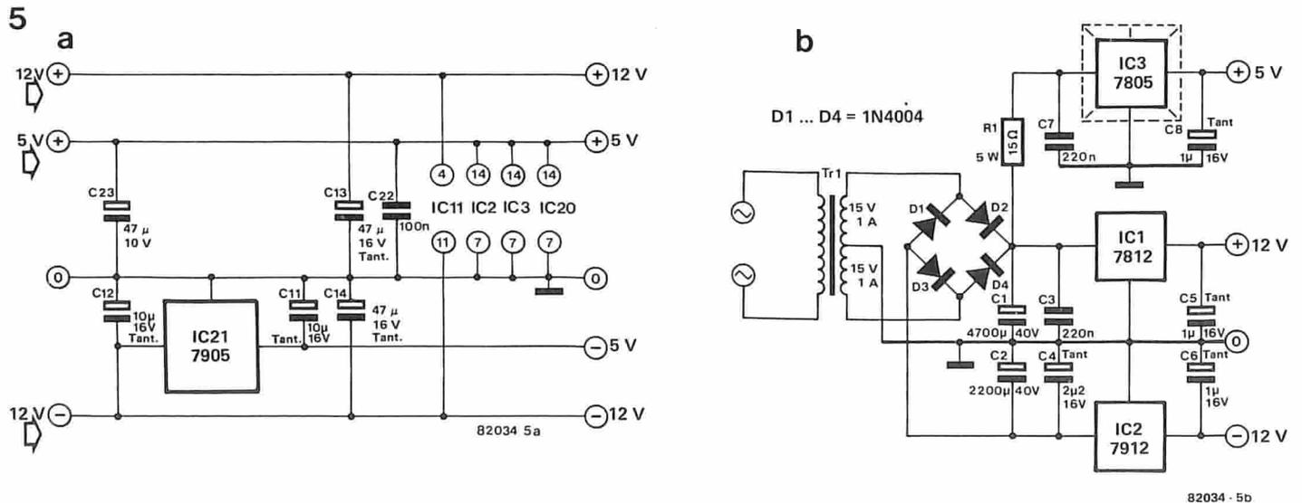
Figura 5. L'alimentazione per la scheda parlante può essere ricavata da quella del computer che la ospita (figura 5a). Altrimenti si potrà costruire facilmente un alimentatore separato (figura 5b).
