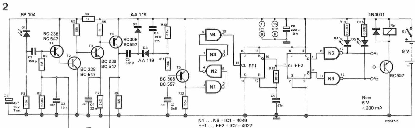
Figura 2. Lo schema elettrico del ricevitore a raggi infrarossi monocanale.
