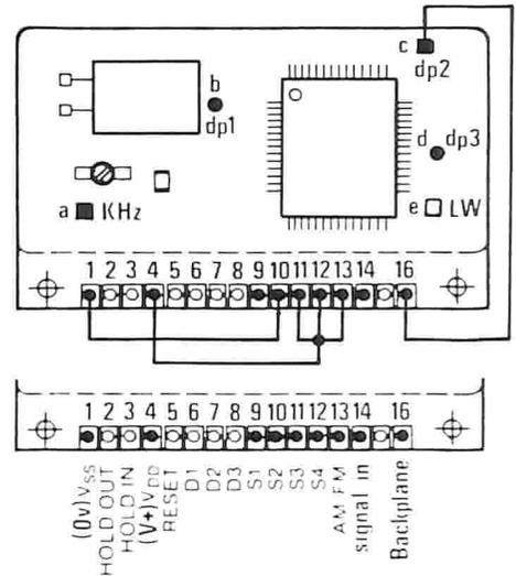
Figura 3. Il modulo del frequenzimetro. I collegamenti indicati andranno fatti durante il montaggio.
