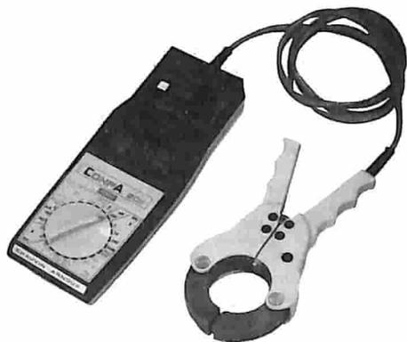
effetto Hall adatta per l'impiego con i multimetri CONPA 2010 e 2011.
