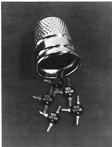
Con il BFR96, che è un transistor NPN con una frequenza di taglio di 4,5 GHz, si può disporre una potenza di 500 mW. Esso fornisce un'uscita di 600 mV con una distorsione di intermodulazione di -60 dB e un punto di compressione di 1 db di 20 dBm a 1 GHz e 60 mA.
