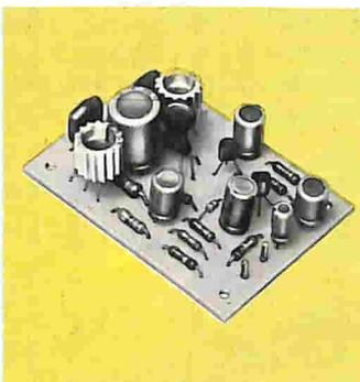
Circuito miniaturizzato di uso universale per applicazioni su apparecchi radio portatili, fonovaligie, microregistratori ecc. Ottimo per funzionare in combinazione con il sintonizzatore UK 521. Ottima fedeltà e sensibilità.
