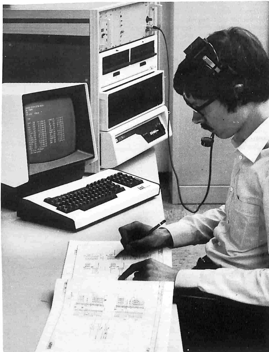
Fotografia. Il sistema di ricezione acustica dei dati (ADES) della AEG-Telefunken, viene qui usato per produrre schemi di cablaggio. L'operatore può inserire i dati ricavati dallo schema direttamente nel computer, attraverso un microfono. Successivamente il computer "rilegge" il display dei dati comunicandoli in una cuffia, in modo da poter correggere tutti gli errori. (Foto AEG Telefunken).
