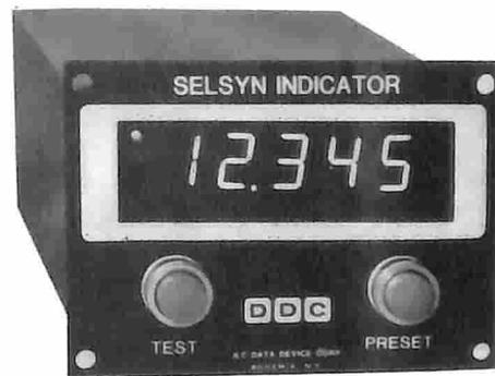
Corporation. Denominato SPI-30800, questo strumento basato su microcomputer viene a sostituire i tradizionali produttometri e altri dispositivi elettromeccanici simili. Esso è ideale per visualizzare e registrare il movimento fisico in pollici, piedi, metri o centimetri così come in libbre, galloni o litri.
