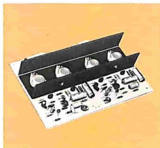
Amplificatore stereo fonico di potenza che può soddisfare la maggior parte delle necessità del tecnico e dell'amatore dell'HI-FI.
