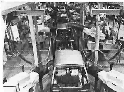
Una delle due linee di saldatura sincronizzata per la metro.
