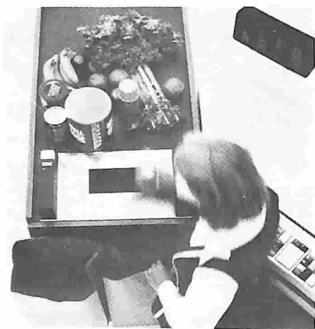
Figura 1. L'analizzatore di controllo IBM 3687 è un gruppo compatto che può essere facilmente inserito tra le attrezzature di cassa dei punti di vendita. La semplicità dell'apparecchio ne permette l'installazione da parte di personale non specializzato, ed elimina la necessità di messe a punto periodiche.
