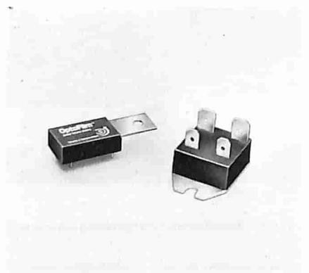
La versione OFA-1205D è in package DIP a 16 pin, ma ha una linguetta elettricamente isolata che può essere equipaggiata con un dispersore di calore esterno. Questo tipo è molto simile ai packages plastici TO-220 per triac o transistor.
