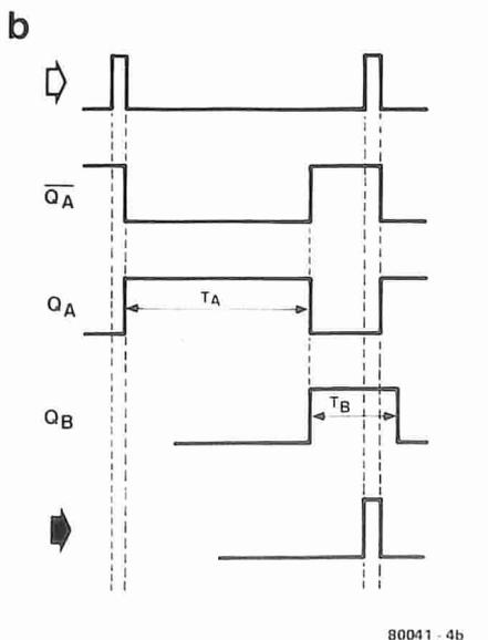
Figura 4. Il funzionamento del filtro digitale. Quattro di questi filtri sono usati nel ricevitore. La figura 4a mostra lo schema e la figura 4b il diagramma degli impulsi.
