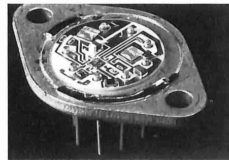
L'ICH 8515 è stato ottimizzato per funzionare con tensioni di alimentazione di  $\pm 12V$  o  $\pm 15V$  e fornisce una corrente di 1,5 A, comportandosi come un vero amplificatore operazionale (guadagno superiore a 100 dB).
