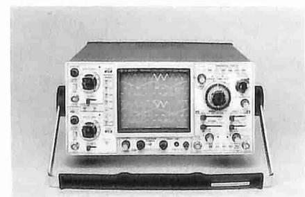
ce, sweep ritardato per consentire di osservare contemporaneamente lo sweep ritardato e quello principale, sweep A e B completamente indipendenti, impedenza di 50  $\Omega$  selezionabile per la visualizzazione dei segnali e degli impulsi veloci sulle linee a 50  $\Omega$ , intensità dello sweep principale e di quello ritardato regolabile in modo indipendente, potenziale di accelerazione di 16 KV e messa a fuoco automatica.
