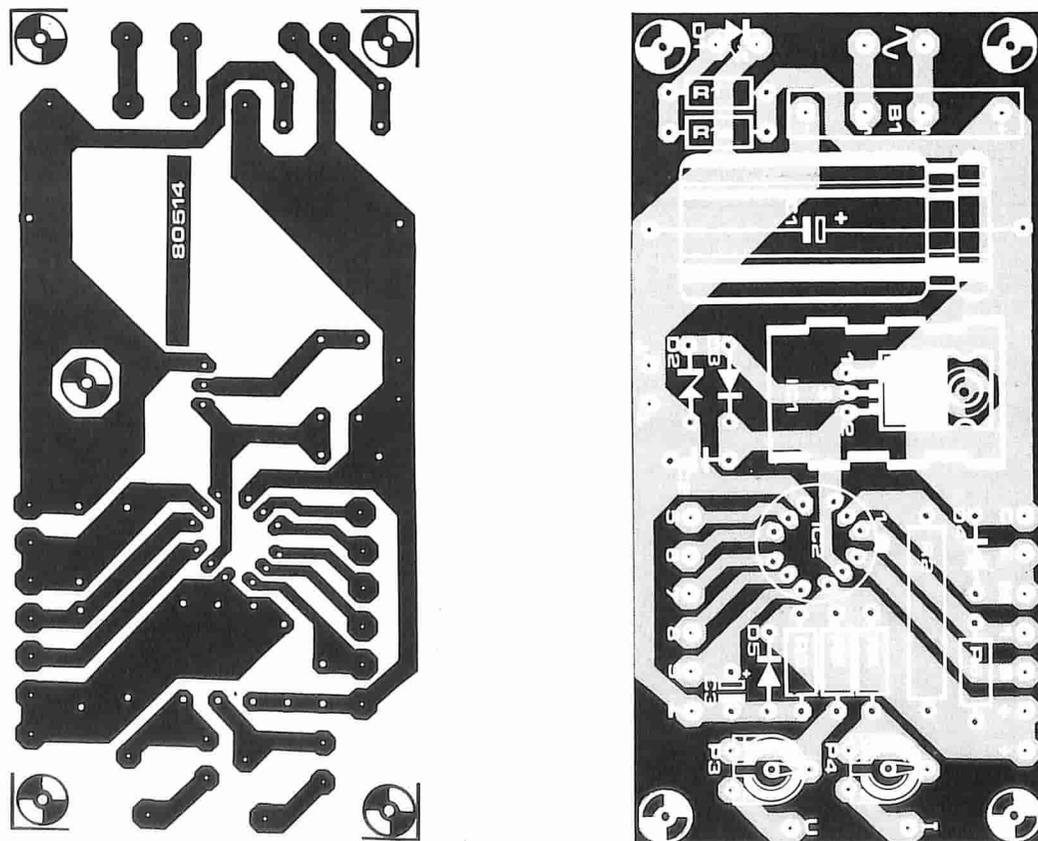
Figura 5. Basetta stampata e disposizione dei componenti del generatore di tensioni campione. Lo zoccolo di IC2 può essere ricavato da una striscia di contatti.
