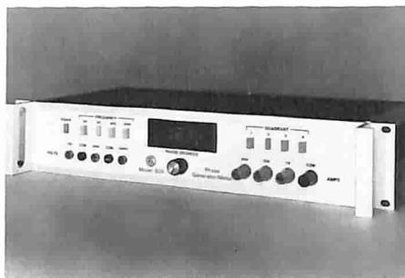
Il range della misura della fase o della generazione della fase è  $\pm 180^\circ$ .
