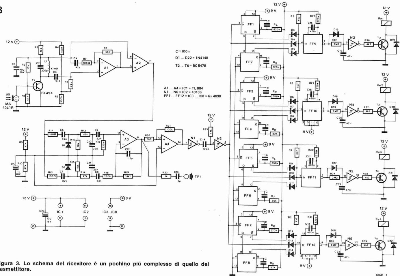
Figura 3. Lo schema del ricevitore è un pochino più complesso di quello del trasmettitore.
