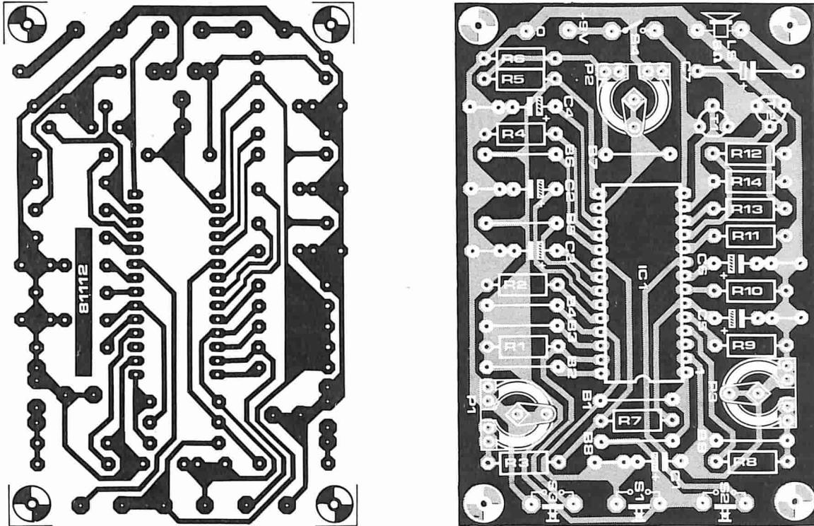
Figura 10. Questo circuito stampato è stato disegnato per ospitare tutti i componenti dei circuiti descritti. I componenti superflui possono essere omessi.
