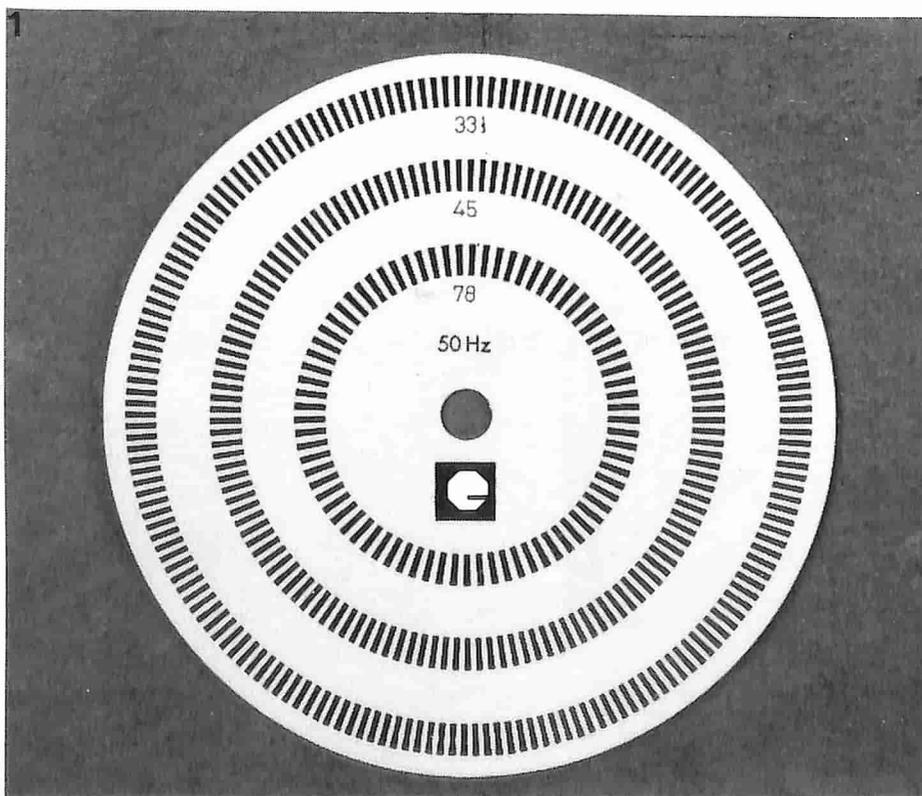
Figura 1. Un disco stroboscopico in grandezza naturale, usato per regolare la velocità dei dischi a  $33\frac{1}{3}$ , 45 e 78 giri sul piatto del fonografo. L'indicazione "50 Hz" si riferisce alla frequenza di rete per la quale il disco è stato progettato.
