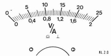
Figura 7. La nuova scala da applicare allo strumento a bobina mobile da 1 mA.
