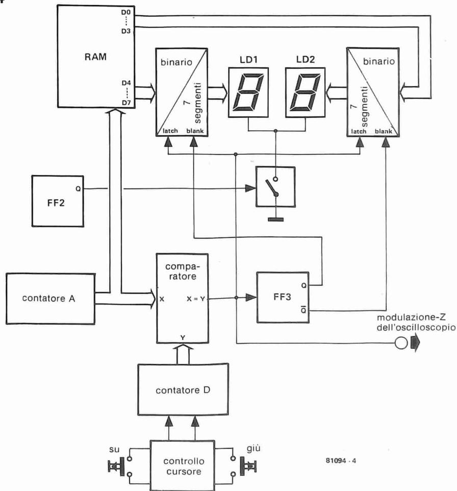
Figura 4. Lo schema a blocchi del controllo del cursore. Sono compresi i due display a LED per la lettura esadecimale. La RAM, FF2 ed il contatore A sono gli stessi della figura 2.
