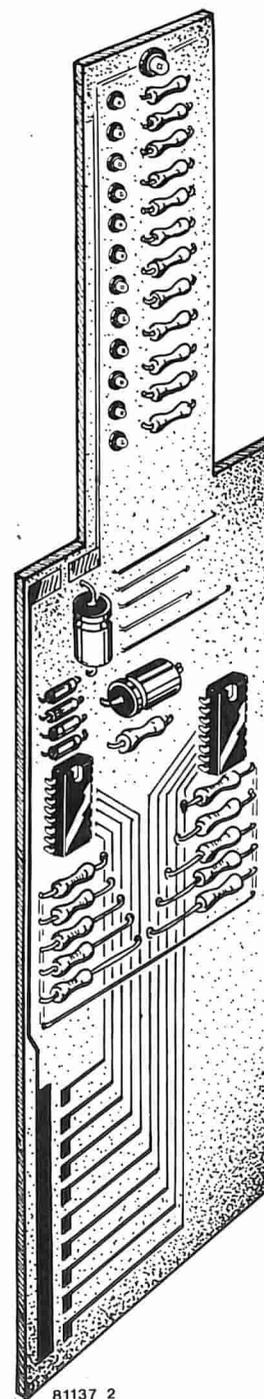
Figura 1. Come costruire la basetta dello strumento. La lunghezza del sensore si deve trovare empiricamente. Nel prototipo essa era di circa 5 cm.
