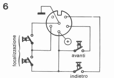
Figura 6. Un sistema di collegamento comune a molti proiettori di diapositive. I contatti dei relé di figura 3 saranno collegati in parallelo ai terminali dei pulsanti.
