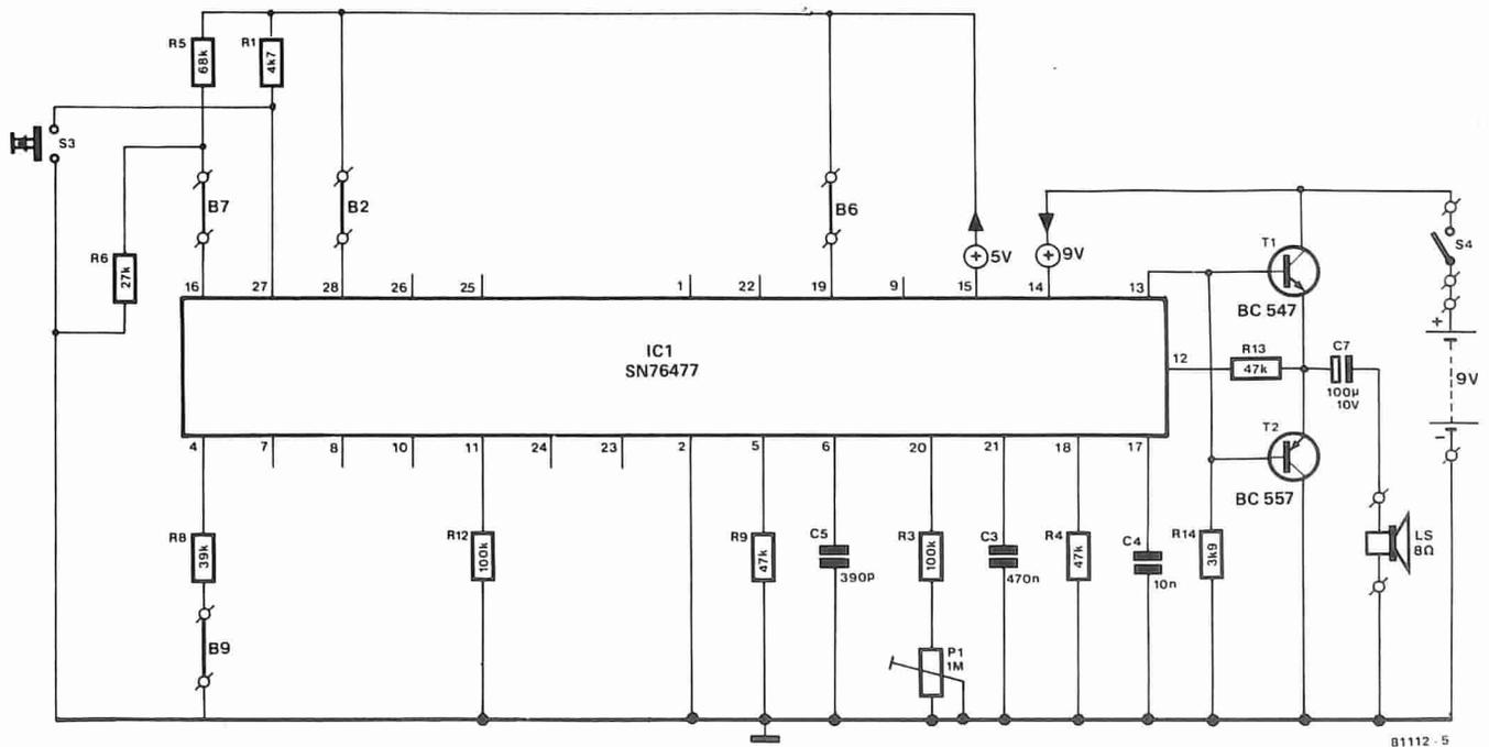
Figura 5. Circuito per treno a vapore con fischio. La velocità del treno può venire controllata mediante P1, mentre S3 aziona il fischio.
