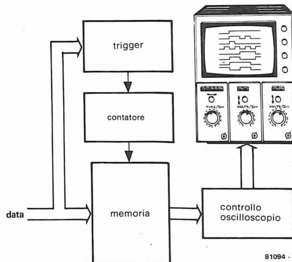
Figura 1. Un semplicissimo schema a blocchi dell'analizzatore logico che mostra l'interrelazione tra memoria, sistema di trigger, clock e controllo dell'oscilloscopio.
