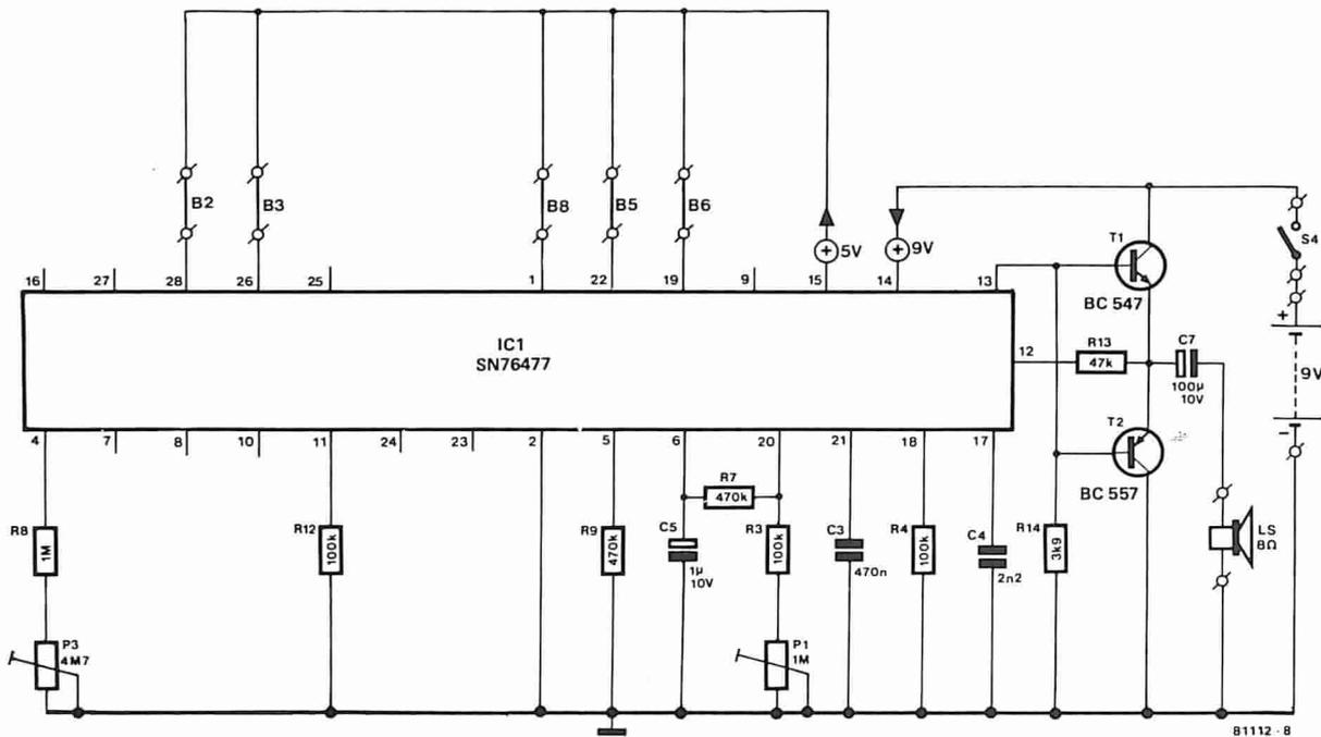
Figura 8. Circuito per cinguettio d'uccelli. Regolando con cura P3 si riesce ad ottenere un cinguettio molto realistico!
