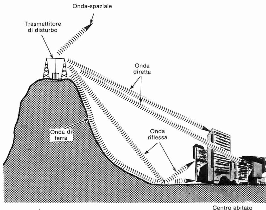
Figura 1. Il disturbo locale consiste principalmente di un'onda diretta e di un'onda riflessa. L'onda di terra ha un'importanza quasi trascurabile in questo tipo di disturbo.
