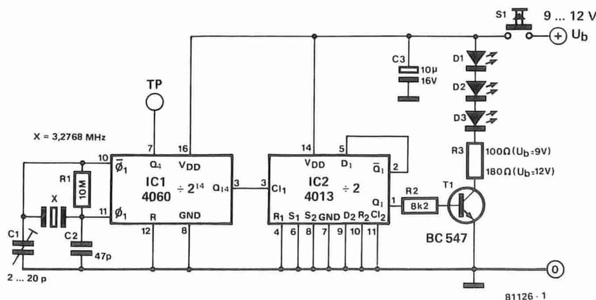
Figura 3. Lo stroboscopio controllato a quarzo rende possibile regolare con la massima precisione la velocità di rotazione del giradischi. I LED, alimentati con tensione ad onda quadra, producono un'immagine migliore e più distinta di quella che si ottiene con qualsiasi lampada ad incandescenza od al neon; inoltre si evitano le imprecisioni della frequenza di rete.
