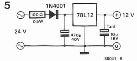
Figura 5. Si può usare questo circuito per alimentare il ricevitore ricavando la tensione dal trasformatore a 24 V.
