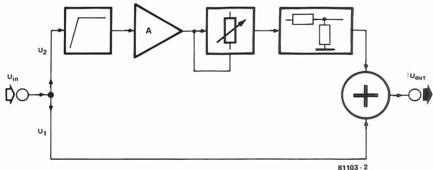
Figura 2. Lo schema a blocchi del sistema DNL. Questo funziona solo durante la riproduzione.
