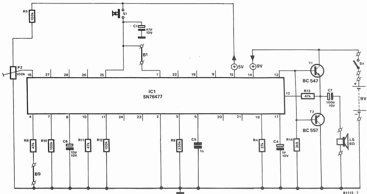
Figura 7. Circuito per auto da corsa ed autoscontro. Il suono del motore dell'auto è regolato tramite P2. Lo scontro si ha premendo S1.
